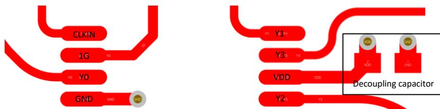
図 9-4. レイアウト例 (8 ピン PW デバイス)
