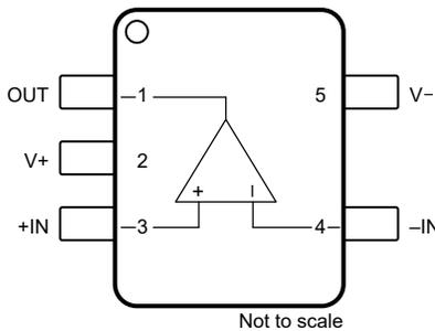
図 4-1. DBV Package, 5-Pin SOT-23 (Top View)
