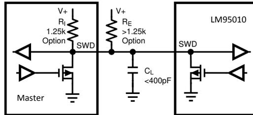
図 6-1. SensorPath SWD の簡略化された回路図
