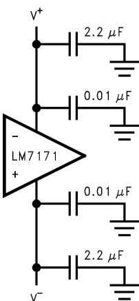
図 6-6. Power-Supply Bypassing
