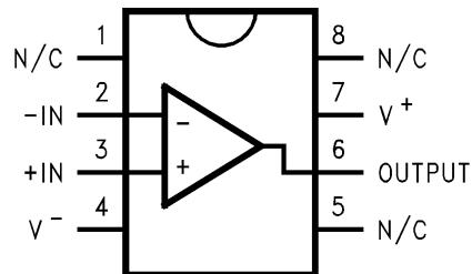
図 4-1. D Package, 8-Pin SOIC (Top View)
