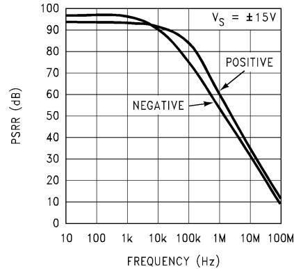
图 5-49. PSRR vs Frequency
