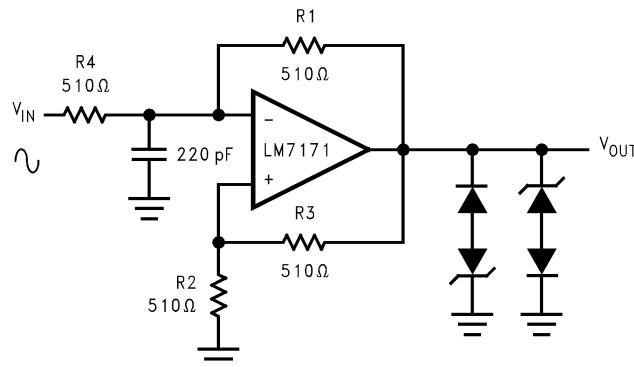
図 6-4. Pulse Width Modulator
