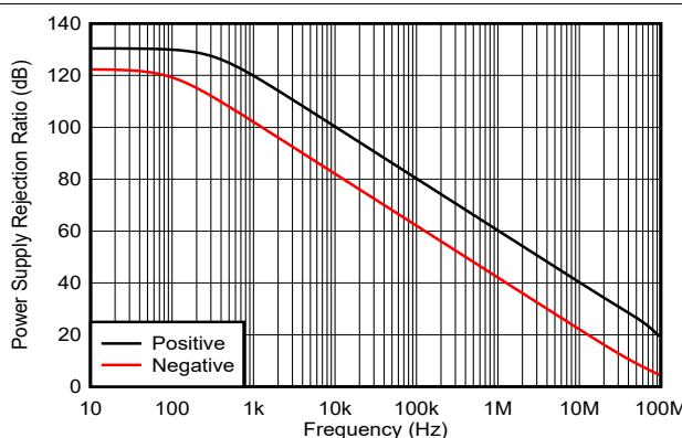
图 5-10. PSRR vs Frequency
