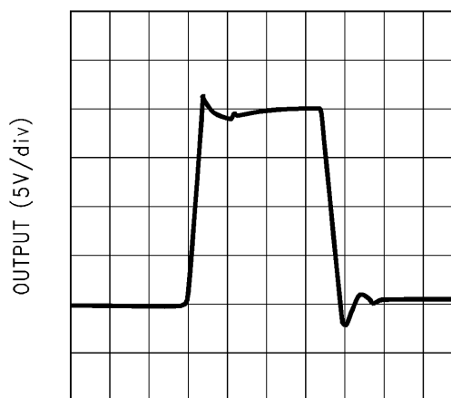
大信号パルス応答 A_V = +2 , V_S = \pm 15V
