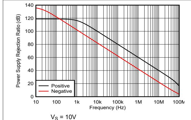
图 5-11. PSRR vs Frequency
