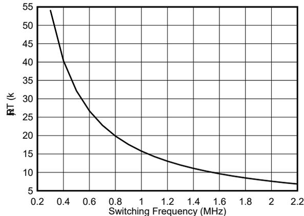
图 7-6. Switching Frequency vs RT
