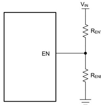
図 7-2. VIN UVLO Using the EN Pin
