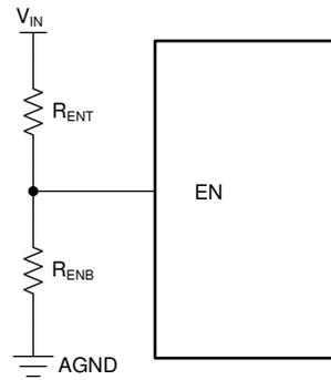
图 7-2. VIN UVLO Using the EN Pin
