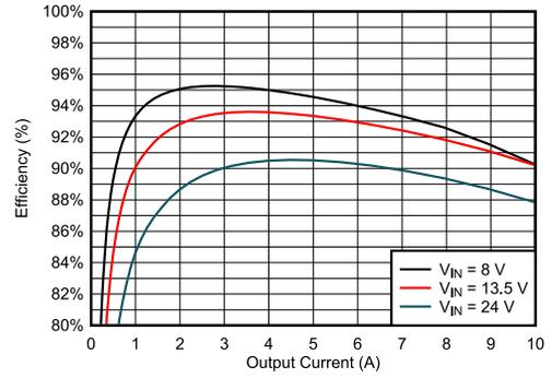
EVM の効率 :  $V_{OUT} = 5V$ 、 $F_{SW} = 2.2MHz$
