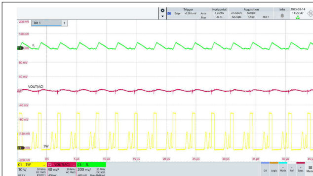
図 7-8. DCM Steady State Ripple
