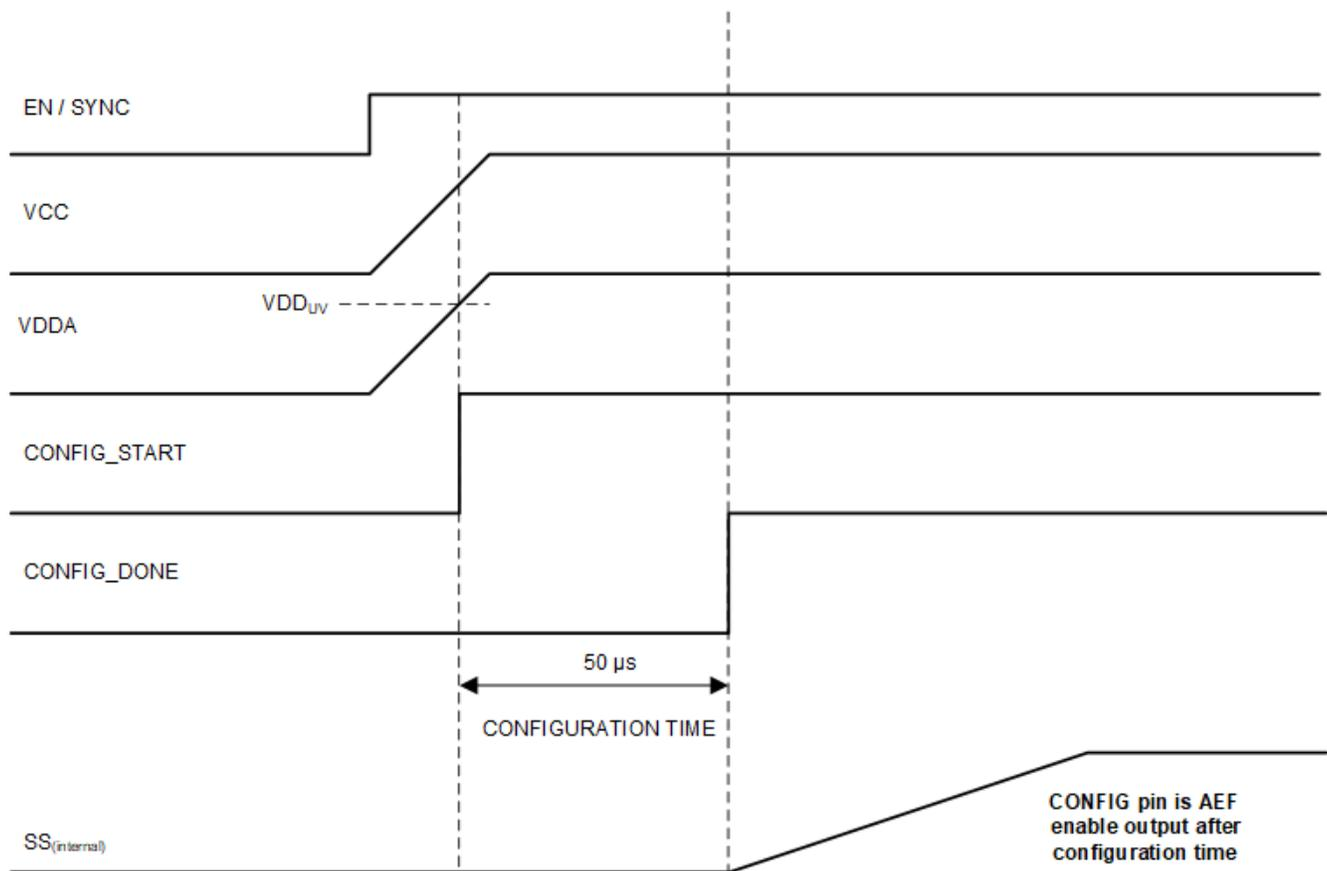
**图 8-7. Configuration Timing**
