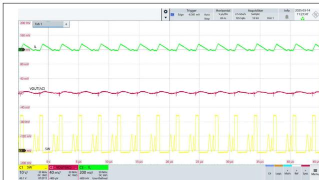
**图 7-8. DCM Steady State Ripple**
