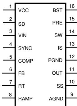
図 4-1. PW Package 16-Pin TSSOP (Top View)
