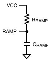
図 6-6.  $R_{RAMP}$  to  $V_{CC}$  for  $V_{OUT} > 7.5V$
