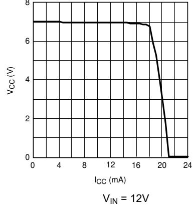
図 5-4.  $V_{CC}$  vs  $I_{CC}$
