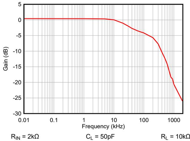
図 9-6.  $R_L = 10\text{k}\Omega$  での帯域幅
