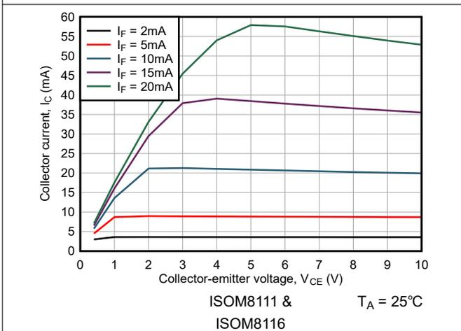
図 6-5. コレクタ電流とコレクタ-エミッタ電圧の関係
