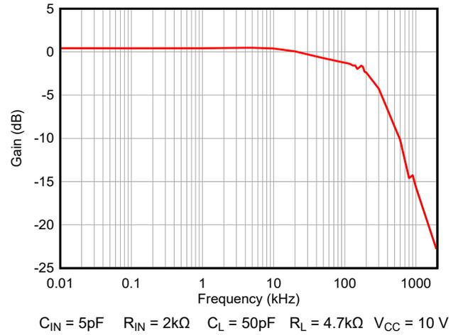
図 9-5.  $R_L = 4.7\text{k}\Omega$  での帯域幅
