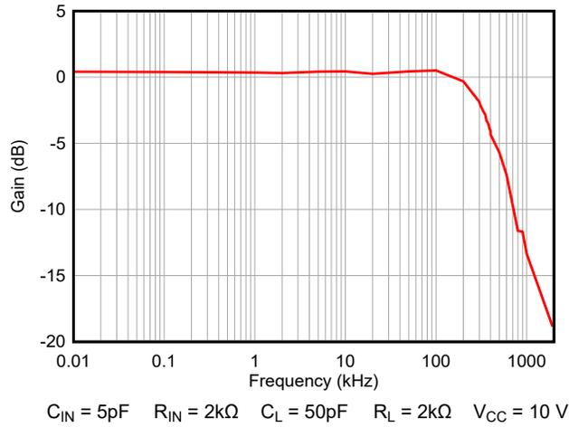
図 9-4.  $R_L = 2\text{k}\Omega$  での帯域幅
