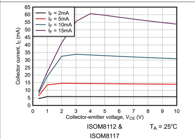
図 6-6. コレクタ電流とコレクタ-エミッタ電圧の関係
