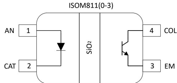
図 5-1. ISOM811[0-3] 4ピン SOIC (上面図)
