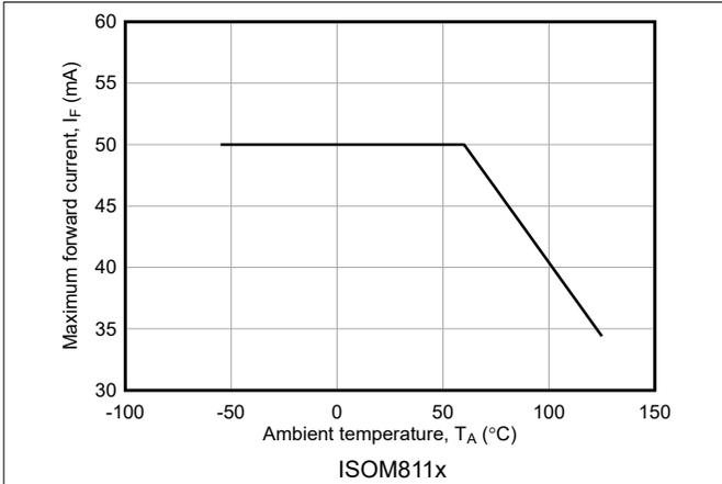
図 6-1. 最大順方向電流と周囲温度との関係
