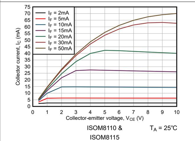
図 6-4. コレクタ電流とコレクタ-エミッタ電圧の関係
