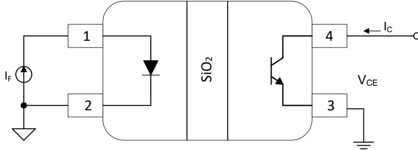
図 7-1. ISOM811x CTR のテスト回路
