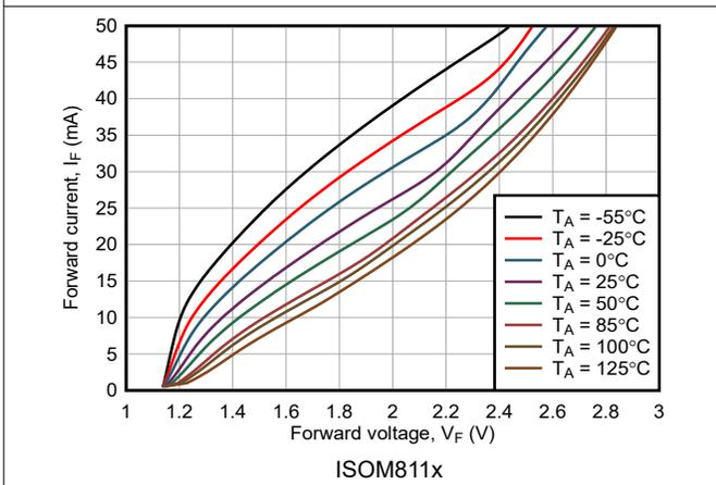
図 6-3. 順方向電圧と順方向電流との関係
