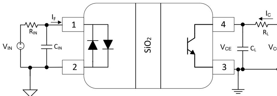
図 7-5. ISOM811[5-8] 帯域幅のテスト回路
