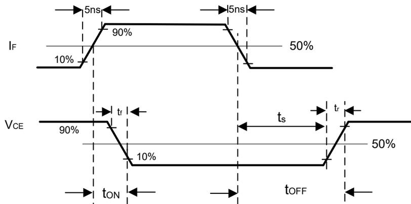
図 7-3. ISOM811x スイッチング タイミング波形
