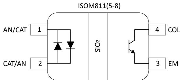
図 5-2. ISOM811[5-8] 4ピン SOIC (上面図)
