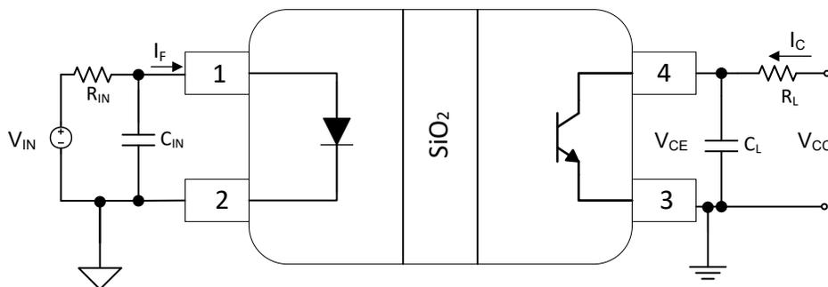
図 7-4. ISOM811[0-3] 帯域幅のテスト回路
