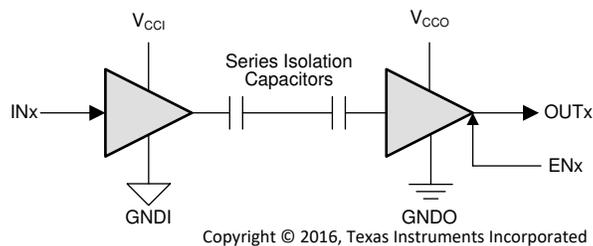
V<sub>CCI</sub>=入力電源、V<sub>CCO</sub>=出力電源
