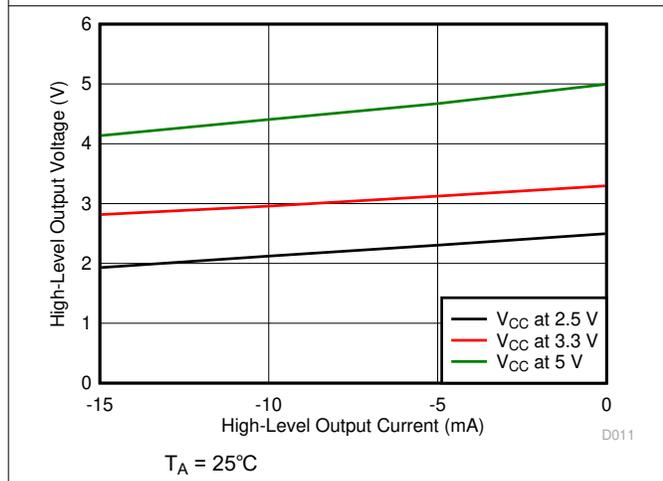
図 5-5. High レベル出力電圧と High レベル出力電流との関係
