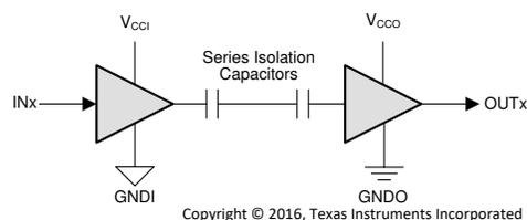
V<sub>CCI</sub> = 入力電源、V<sub>CCO</sub> = 出力電源
