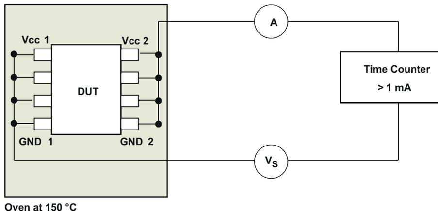
図 9-5. 絶縁寿命測定用のテスト構成
