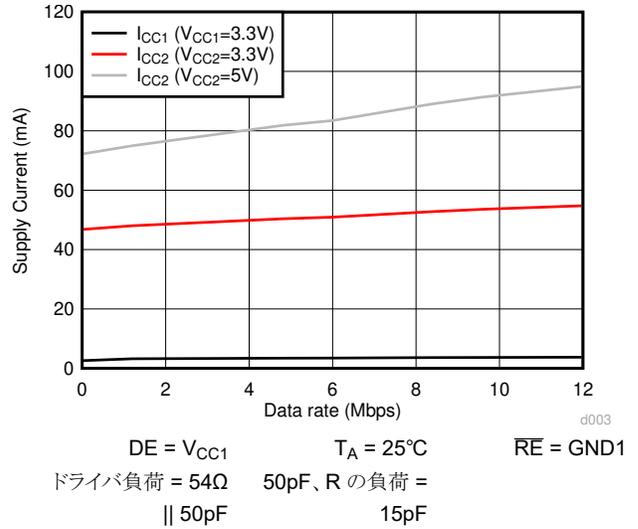
**図 7-8. ISO143x の電源電流とデータ レートとの関係**
