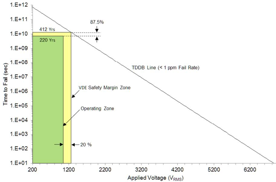
動作絶縁電圧 = 1060V<sub>RMS</sub>
