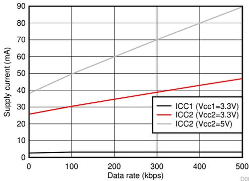
DE = V<sub>CC1</sub> RE = GND1 ドライバ負荷 = 120Ω || 50pF
