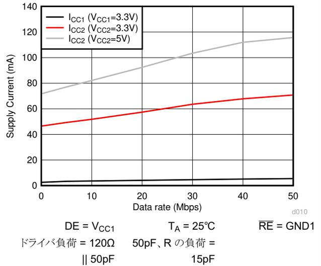
**図 7-10. ISO145x の電源電流とデータ レートとの関係**
