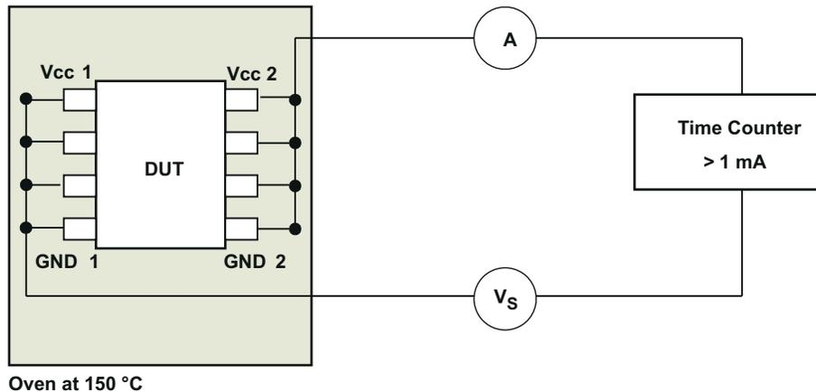
図 10-6. 絶縁寿命測定用のテスト構成
