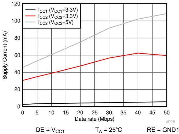
**図 7-9. ISO145x の電源電流とデータ レートとの関係**
