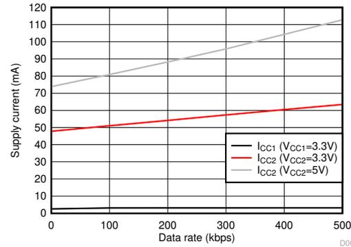
DE = V<sub>CC1</sub> RE = GND1 ドライバ負荷 = 54Ω
