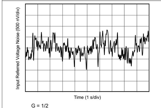
図 7-35. 0.1Hz~10Hz RTI 電圧ノイズ
