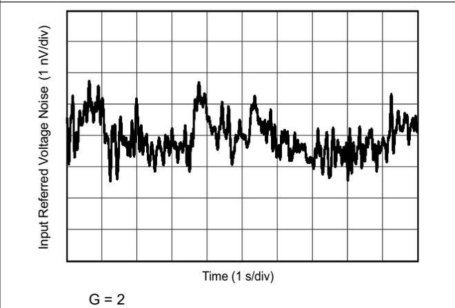
図 7-36. 0.1Hz~10Hz RTI 電圧ノイズ
