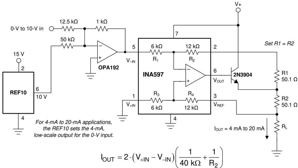
図 9-9. 高精度な電圧 - 電流変換
