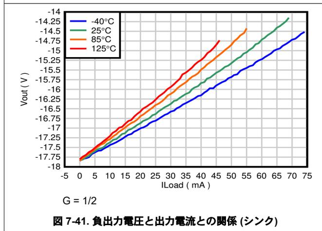
図 7-41. 負出力電圧と出力電流との関係 (シンク)
