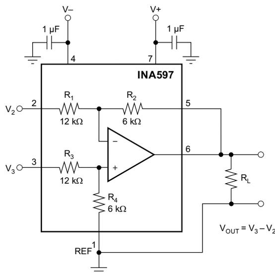
図 9-1. 基本的な電源と信号の接続
