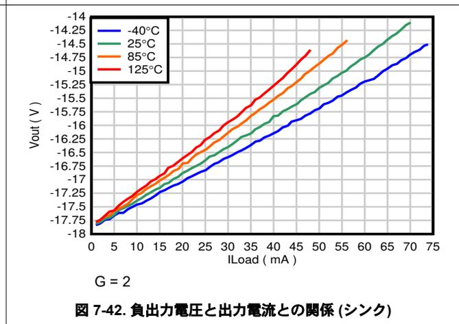
図 7-42. 負出力電圧と出力電流との関係 (シンク)
