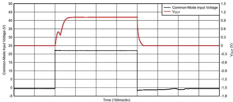
図 8-2. ソレノイド制御電流の応答
