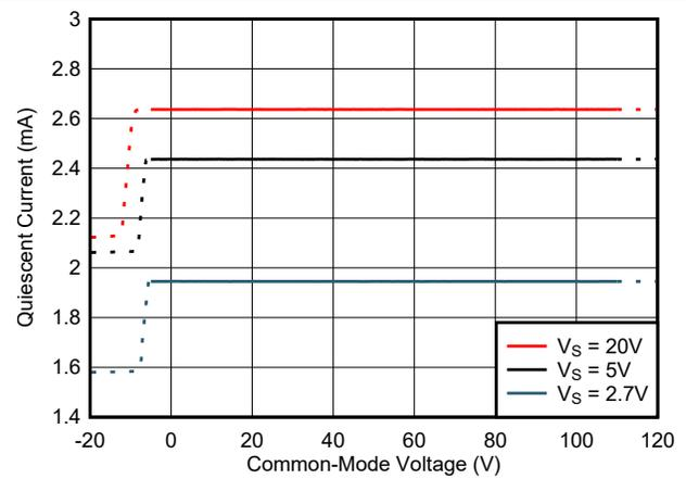
図 6-32. 静止電流と同相電圧との関係
