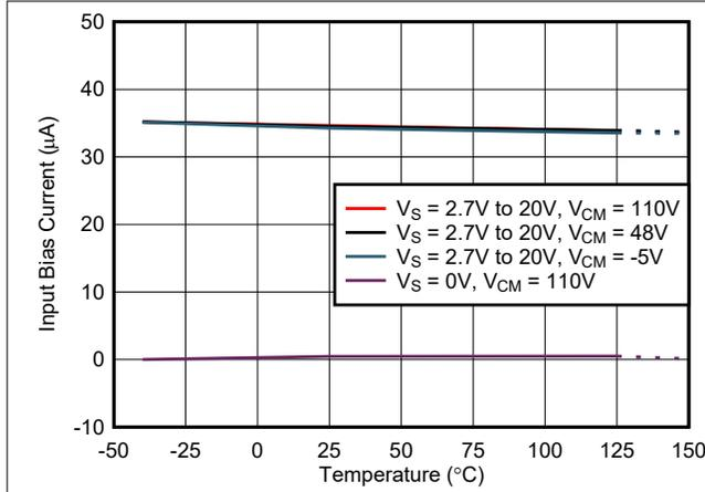
図 6-17. 入力バイアス電流と温度との関係
