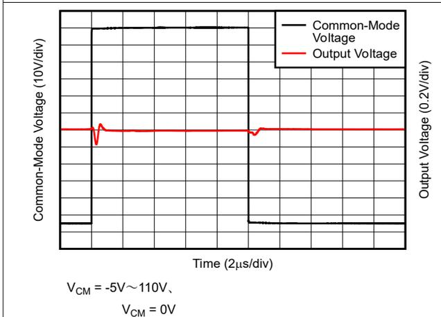
図 6-33. 同相電圧の高速過渡パルス
