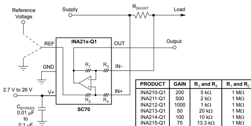
$$V_{\text{OUT}} = (I_{\text{LOAD}} \times R_{\text{SHUNT}}) \text{Gain} + V_{\text{REF}}$$
