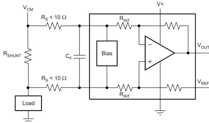
図 6-2. 入力ピンでのフィルタリング
