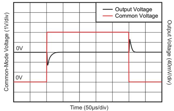
図 5-18. 同相電圧の過渡応答
