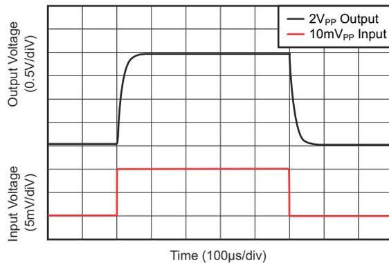
図 5-17. ステップ応答 (10mV<sub>pp</sub> 入力ステップ)
