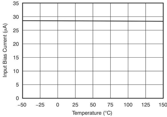
図 5-13. 入力バイアス電流と温度との関係
