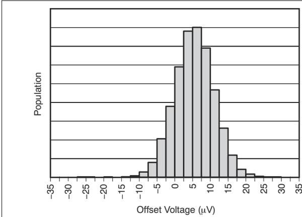
図 5-1. 入力オフセット電圧の製品分布
