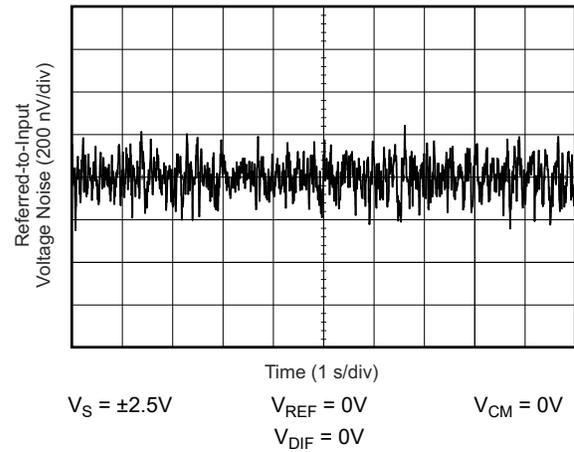
図 5-16. 0.1Hz~10Hz の電圧ノイズ (入力換算)
