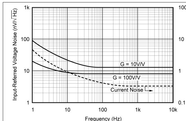
图 6-7. Input-Referred Noise vs Frequency
