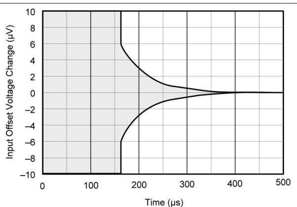
图 6-10. Input Offset Voltage Warmup
