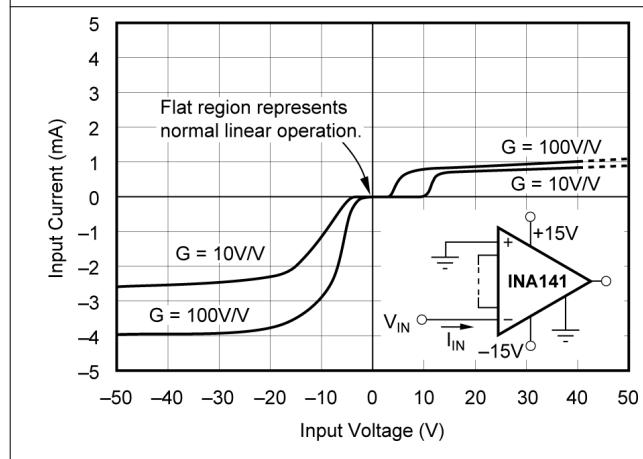
图 6-9. Input Overvoltage V/I Characteristics
