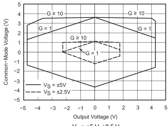
图 7-6. Input Common-Mode Range vs Output Voltage
