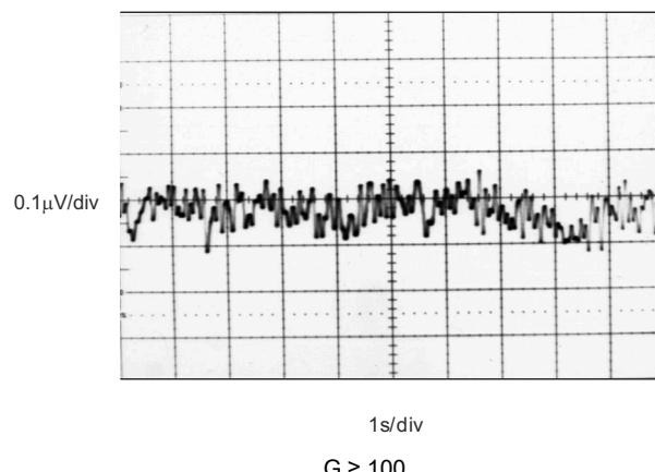
**图 8-1. 0.1-Hz to 10-Hz Input-Referred Voltage Noise**
