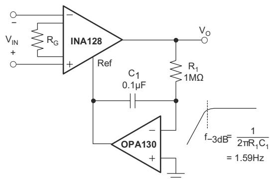
図 9-9. AC-Coupled Instrumentation Amplifier
