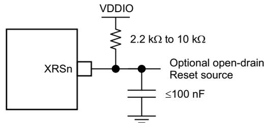
**Figure 6-6. Reset Circuit**
