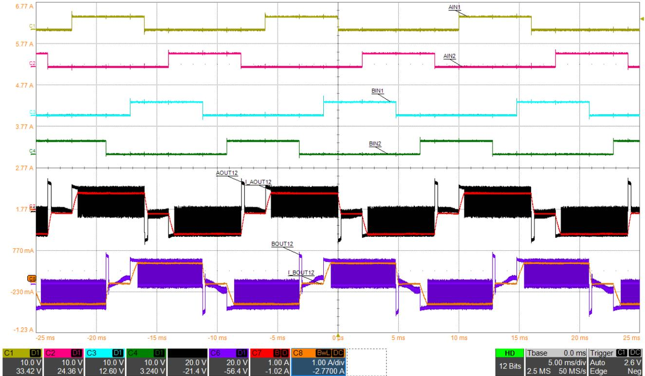
図 9-6. ファースト・ディケイを使用したstepping・モータのhalf・stepping動作
