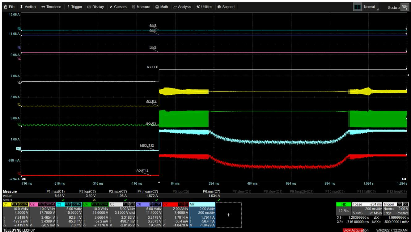
図 9-10. 電流レギュレーション
