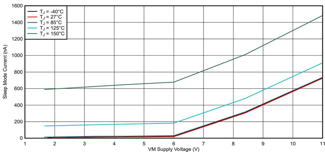
図 7-2. スリープ・モード電流
