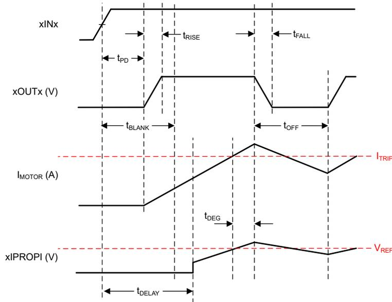
図 8-4. IPROPI の詳細なタイミング図
