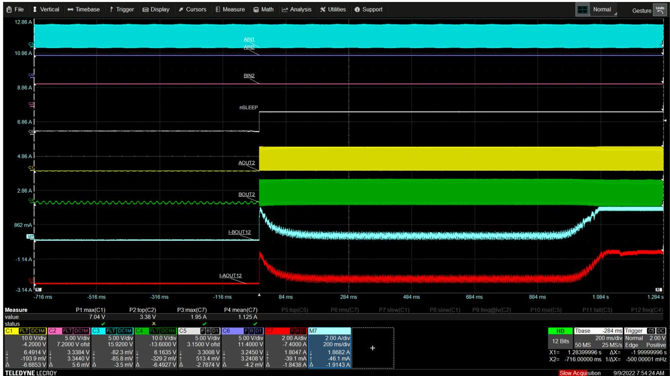
図 9-9. 電流レギュレーションなし
