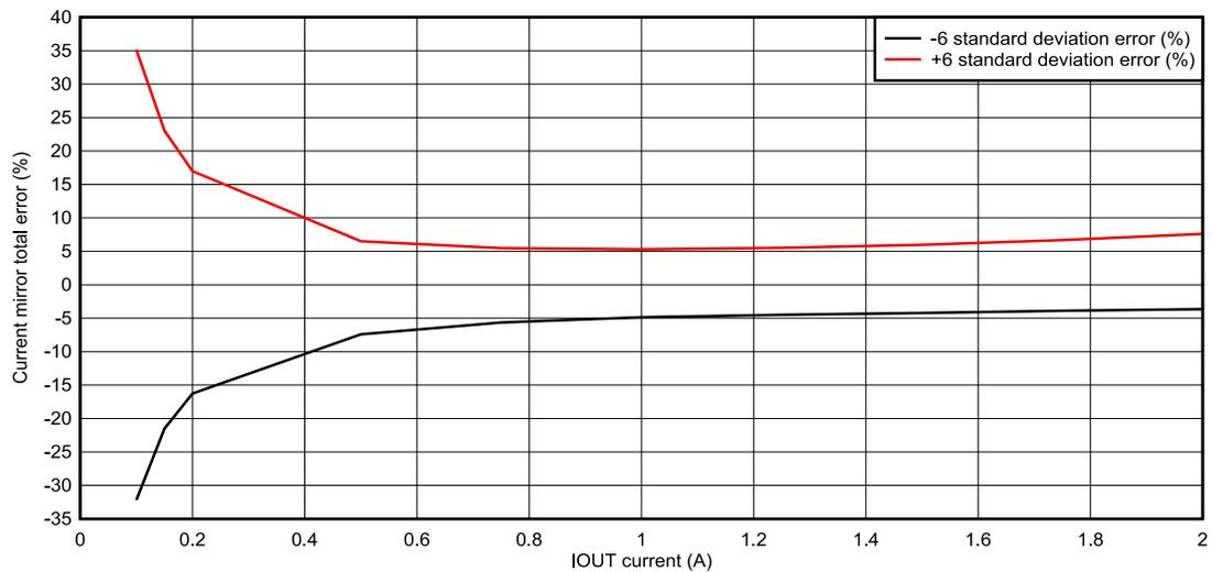
図 7-6. 電流ミラーのスケール係数、VM = 3.3V~11V
