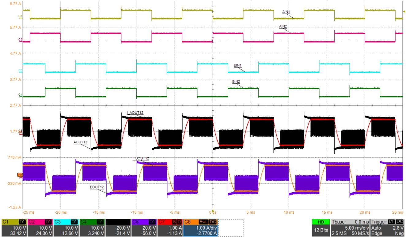
図 9-5. ステッピング・モータのフル・stepping動作
