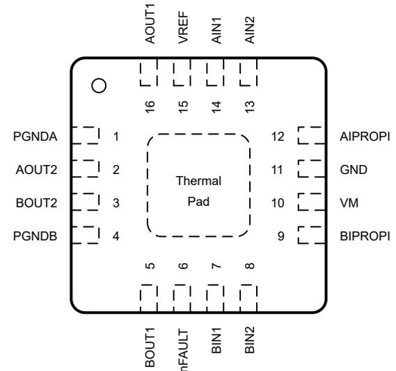
図 5-2. RTE パッケージ 16 ピン WQFN 上面図
