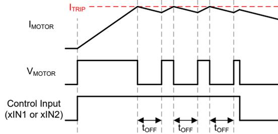
図 8-6. オフ時間電流レギュレーション
