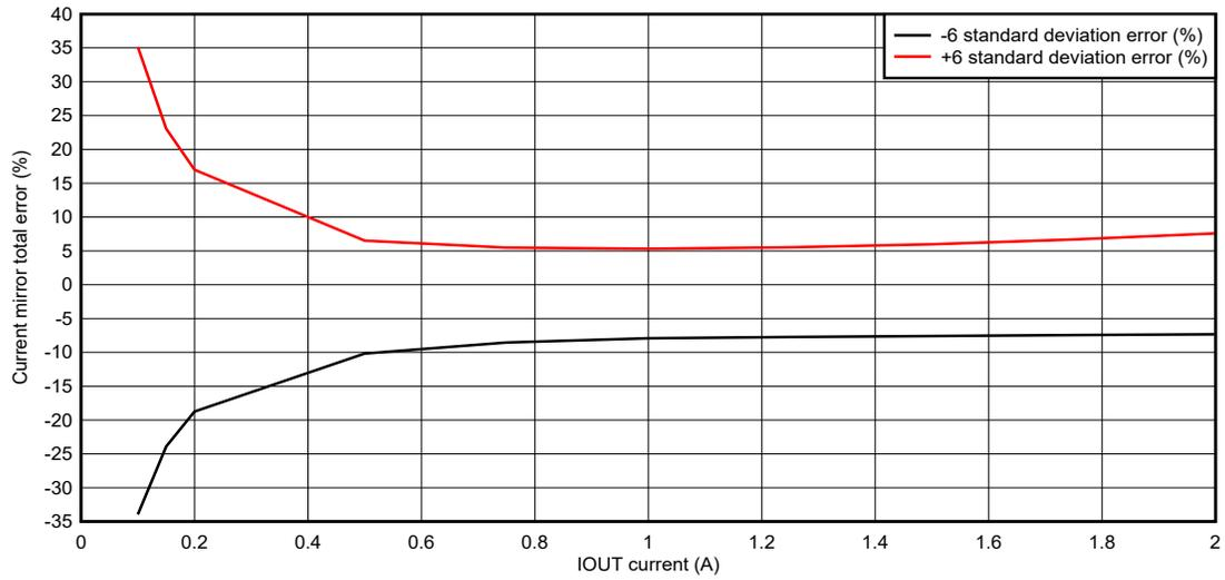
図 7-5. 電流ミラーのスケール係数、VM = 1.65V~3.3V
