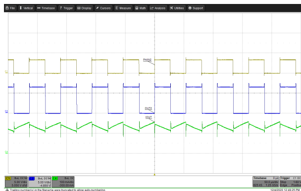
A. チャネル 1 = IN2 チャネル 2 = V_{OUT2} チャネル 4 = モーター電流
