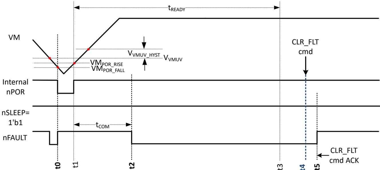
図 6-7. SPI (S) バリエントのパワーアップからスタンバイ状態への遷移
