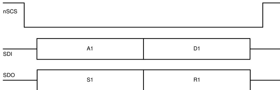
図 7-8. SPI データ - 標準「16 ビット」フレーム
