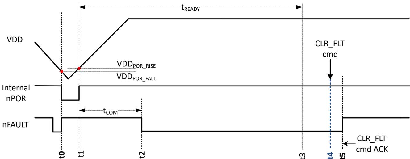
図 6-8. SPI (P) バリエントのパワーアップからスタンバイ状態への遷移
