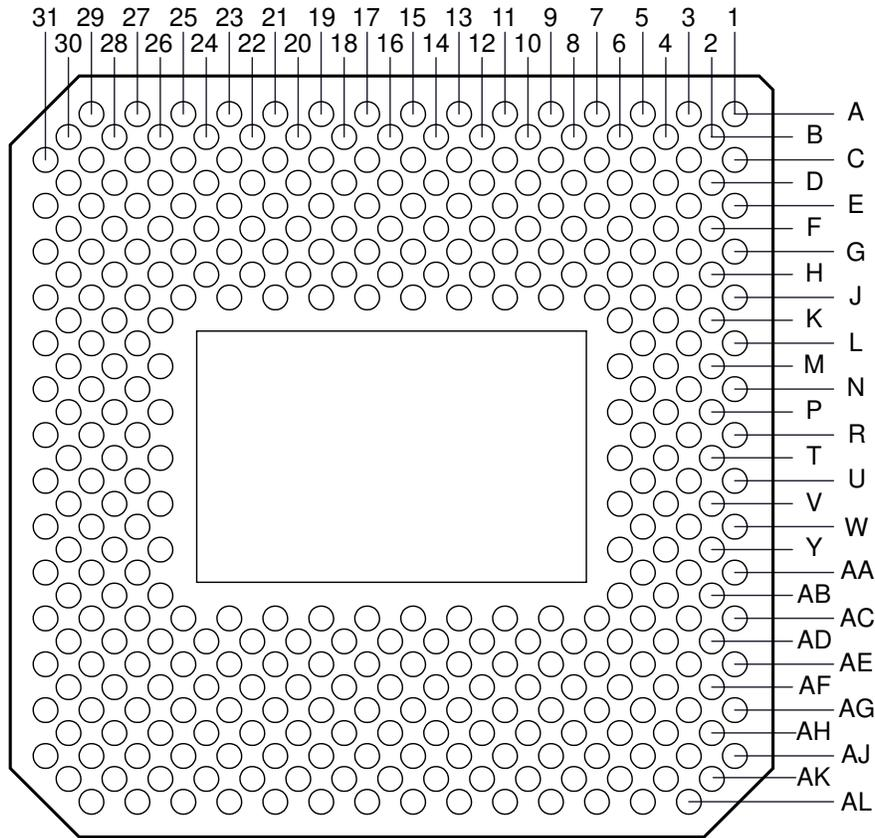
図 5-1. FLN Package 355-Pin LCCC Bottom View
