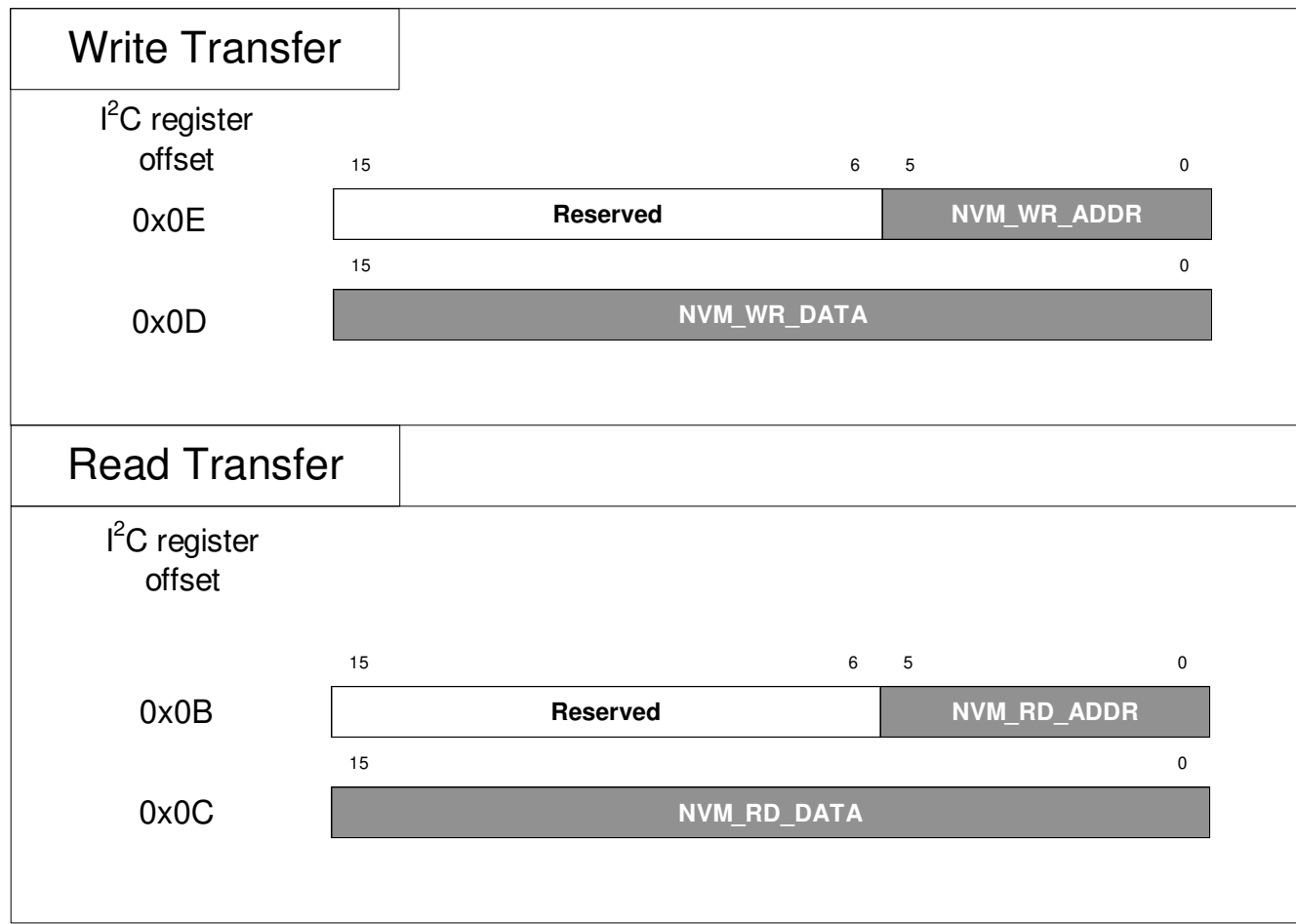
図 10-11. I 2 C を使用した EEPROM ダイレクト・アクセス
