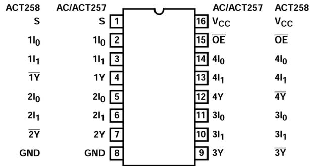
図 3-1. CD54AC257、CD54ACT257 J パッケージ、CD74AC257、CD74ACT257、CD74ACT258 D、N、または PW パッケージ、16 ピン SOIC、PDIP または TSSOP (上面図)
