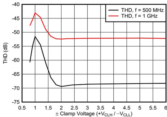
8-4. THD vs V<sub>CLH</sub> / V<sub>CLL</sub> for V<sub>OUT</sub> = 1 V<sub>PP</sub>
