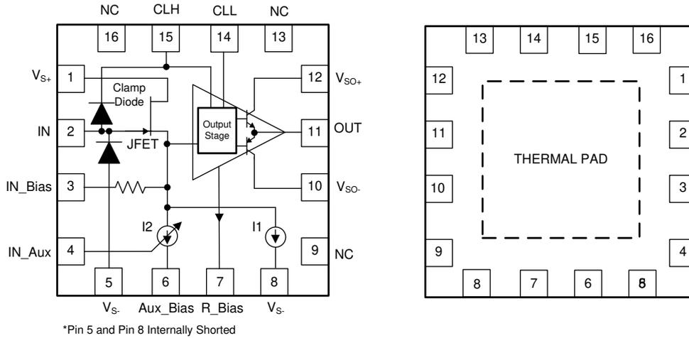
图 5-1. RGT Package, 16-Pin VQFN
