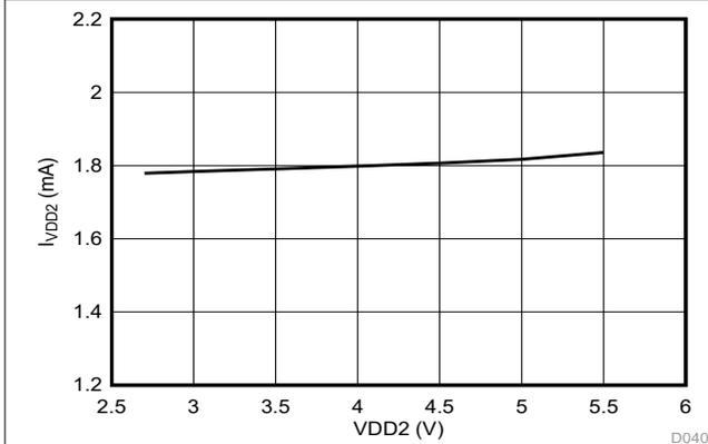
図 5-32. ローサイド電源電流と電源電圧との関係
