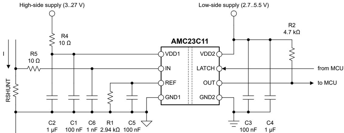
図 7-4. AMC23C11 のデカップリング
