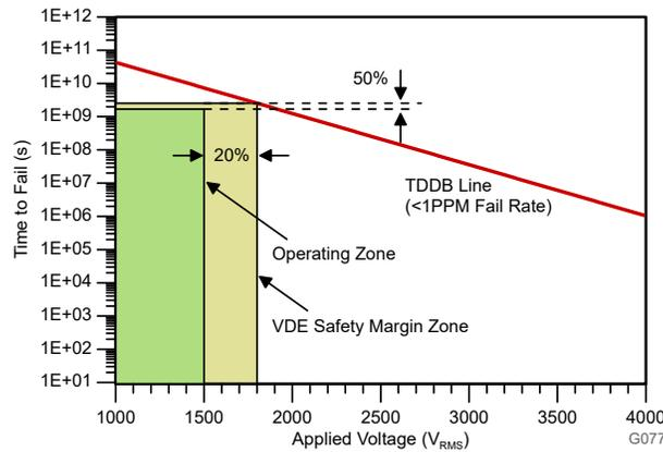
150°Cまでの  $T_A$ 、ストレス電圧周波数 = 60Hz、絶縁動作電圧 = 1000V<sub>RMS</sub>、動作寿命 = 400 年
