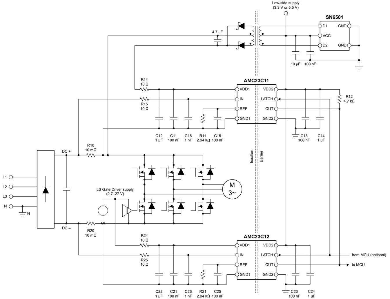
図 7-1. AMC23C11 による DC+ 過電流検出
