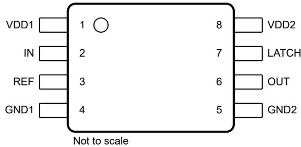
図 4-1. DWV パッケージ、8 ピン SOIC (上面図)
