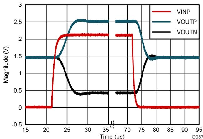
図 8-4. AMC0x11D-Q1 のステップ応答
