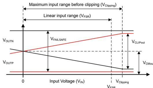
図 7-2. AMC0x11D-Q1 の入力から出力への伝達曲線
