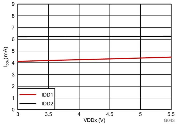
図 6-12. 電源電流と電源電圧との関係
