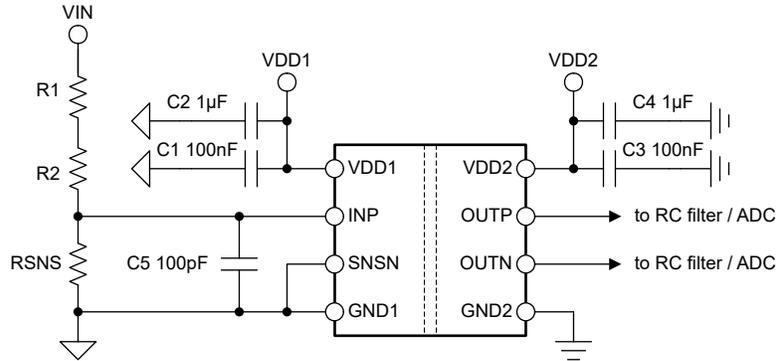
図 8-5. AMC0x11D-Q1 のデカップリング
