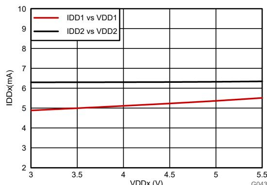
図 6-35. 電源電流と電源電圧との関係
