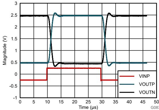
図 8-4. AMC0x00D-Q1 のステップ応答
