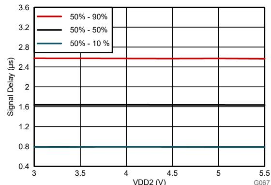
図 6-39. V<sub>IN</sub> から V<sub>OUT</sub> への信号遅延とローサイド電源電圧との関係
