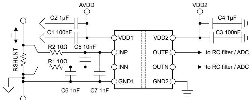
図 8-5. AMC0x00D-Q1 のデカップリング
