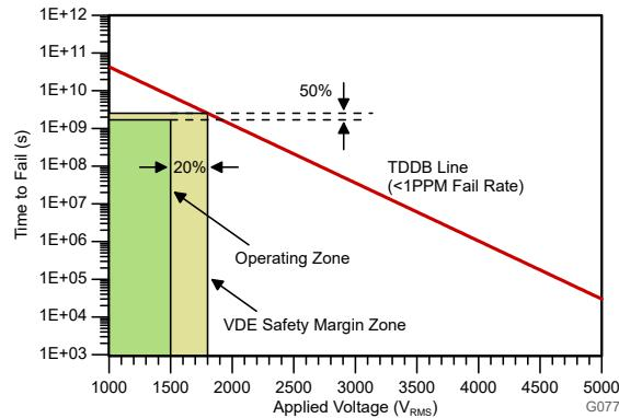
150°Cまでの  $T_A$ 、ストレス電圧周波数 = 60Hz、絶縁動作電圧 = 1500V<sub>RMS</sub>、
