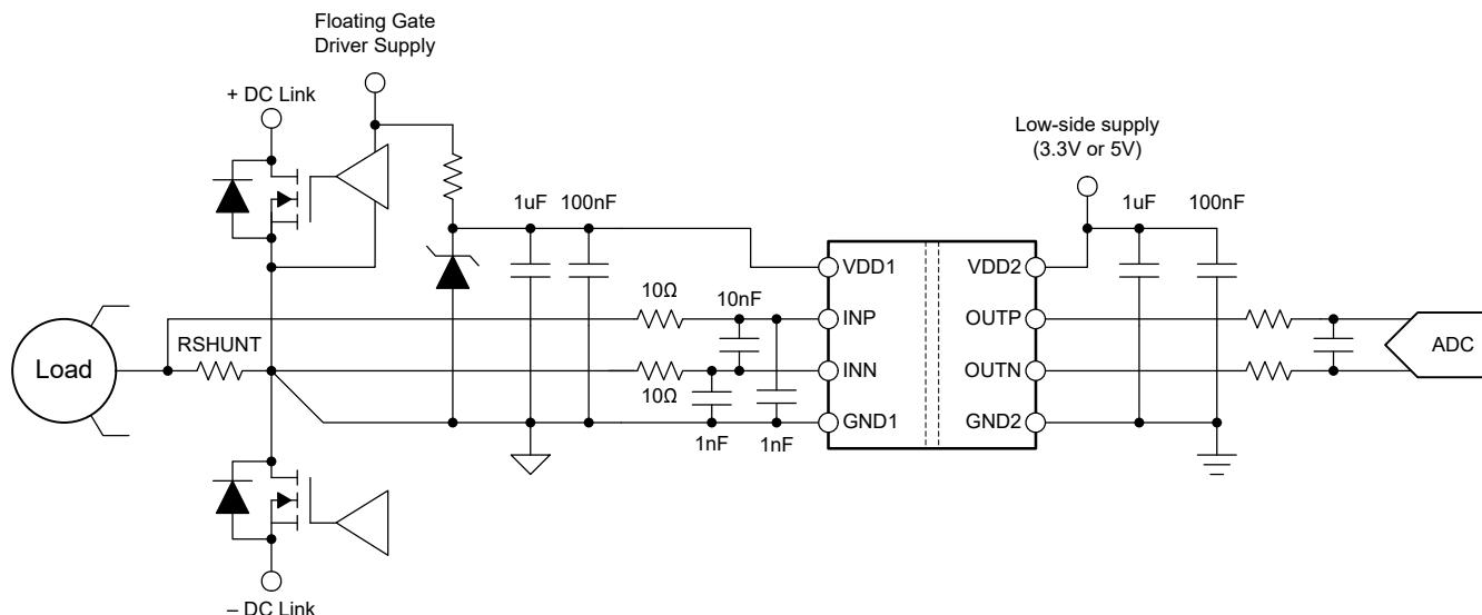
図 8-1. 代表的なアプリケーションでの電流検出に AMC0x00D-Q1 を使用
