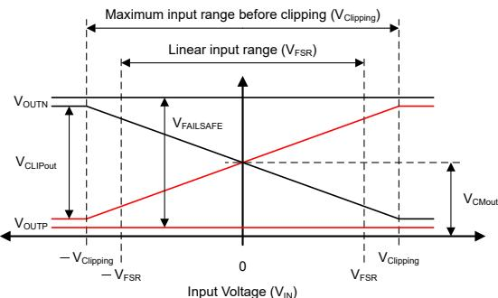
図 7-2. AMC0x00D-Q1 の入力から出力への伝達曲線
