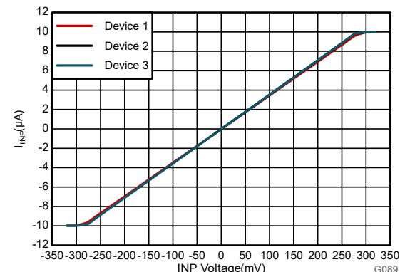
図 6-11. 入力電流と入力電圧との関係
