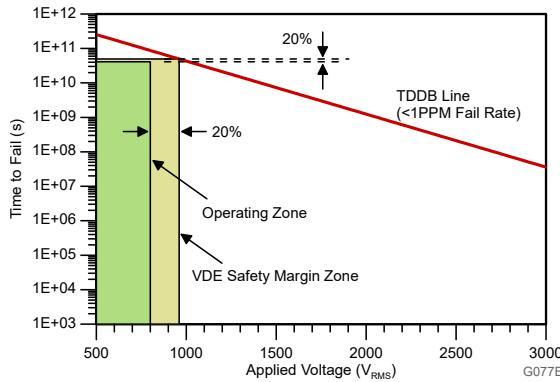
150°Cまでの  $T_A$ 、ストレス電圧周波数 = 60Hz、絶縁動作電圧 = 800V<sub>RMS</sub>、
