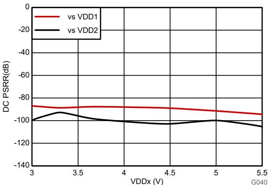
図 6-29. 電源除去比と電源電圧との関係
