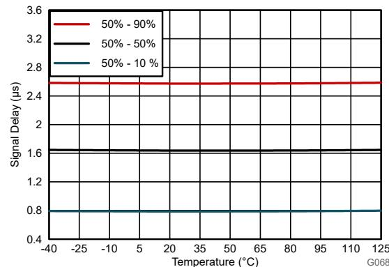
図 6-40. V<sub>IN</sub> から V<sub>OUT</sub> への信号遅延と温度との関係
