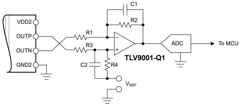
図 8-3. AMC0x00D-Q1 出力をシングルエンド入力 ADC に接続する
