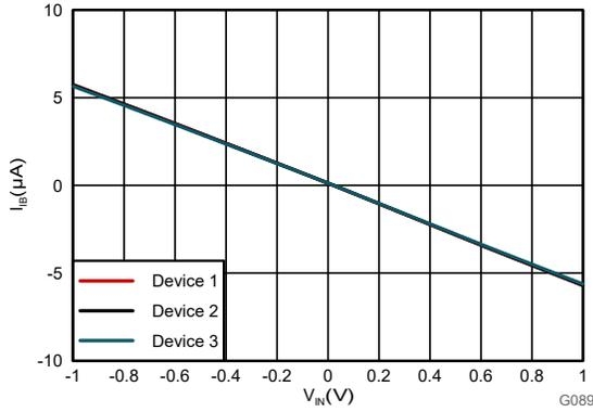
図 6-12. 入力バイアス電流と入力電圧との関係 (SNSN ピン)
