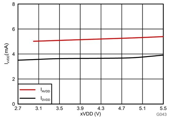
図 6-45. 電源電流と電源電圧との関係
