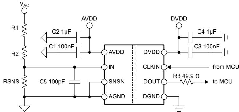
図 8-4. AMC0x36 のデカップリング
