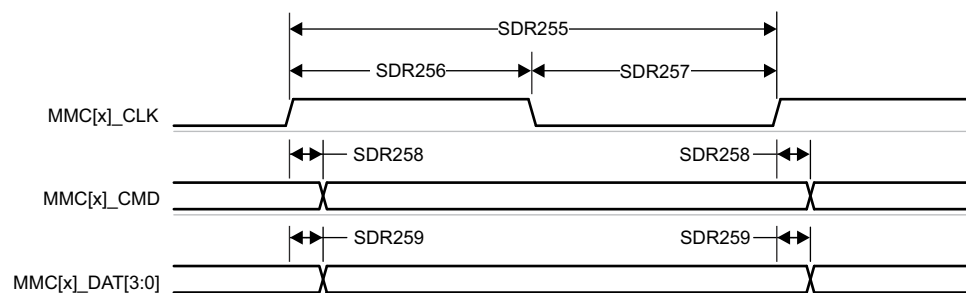
図 6-93. MMC1/2 – UHS-I SDR25 – 送信モード
