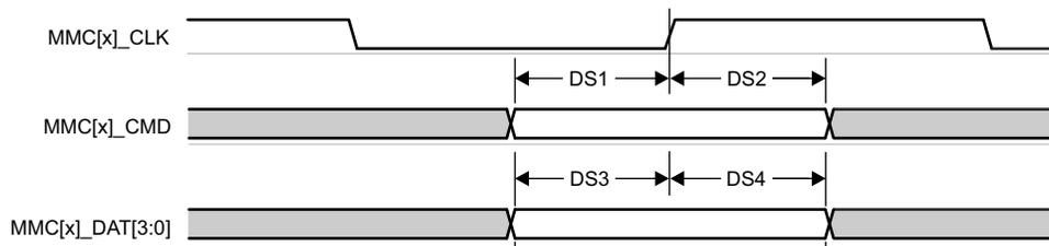
**図 6-81. MMC1/MMC2 – デフォルト速度 – 受信モード**
