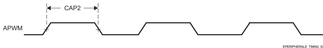
図 6-38. ECAP スwitching特性
