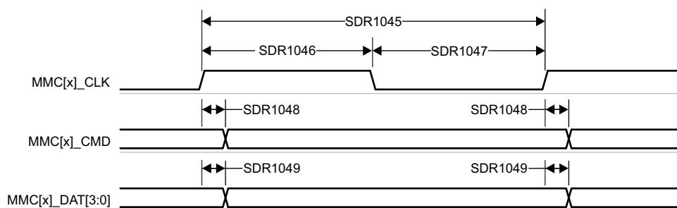
図 6-84. MMC0 – UHS-I SDR104 – 送信モード
