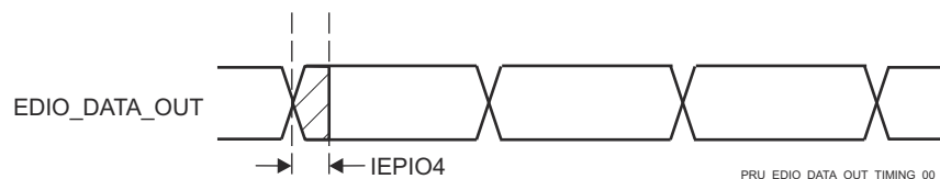
図 7-111. PRUSS IEP デジタル IO のタイミング要件
