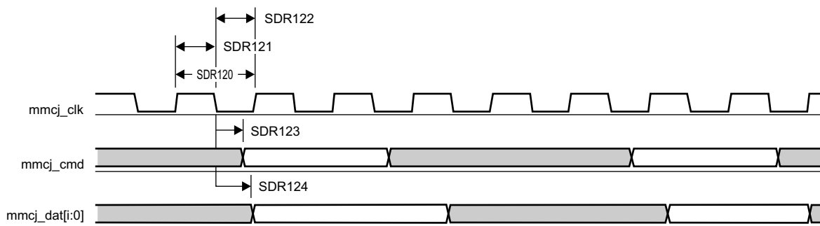
图 7-86. MMC/SD/SDIOj in - SDR12 - Transmitter Mode
