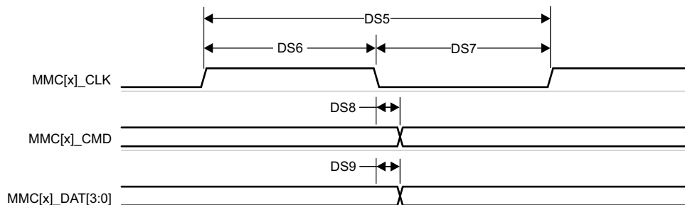
図 6-45. MMC – デフォルト速度 – 送信モード
