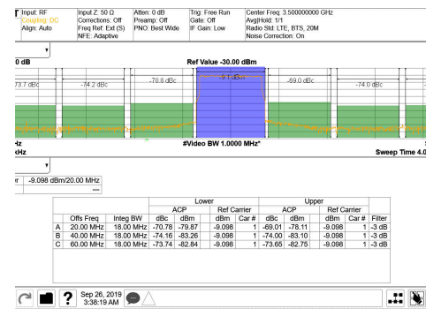
3.5GHz 整合あり、シングル・キャリア 20MHz BW TM1.1 LTE
