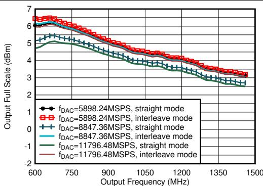
PCB とケーブルの損失を含める。 $A_{\text{out}} = -0.5\text{dBFS}$ 、DSA = 0、
