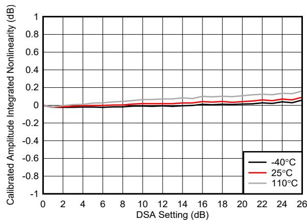
図 4-243. TX DSA 較正済み振幅の積分非直線性
