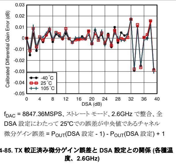
図 4-85. TX 較正済み微分ゲイン誤差と DSA 設定との関係 (各種温度、2.6GHz)
