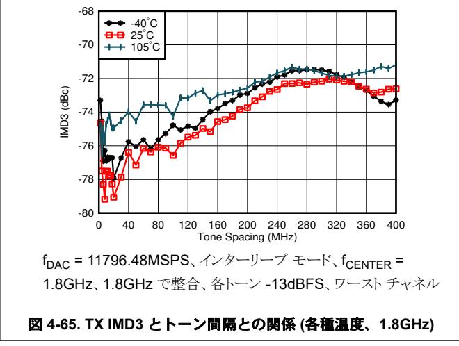
$f_{\text{DAC}} = 11796.48\text{MSPS}$ 、インターリープ モード、 $f_{\text{CENTER}} = 1.8\text{GHz}$ 、1.8GHz で整合、各トーン -13dBFS、ワースト チャネル
