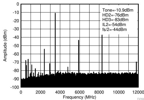
3.5GHz で整合、 $f_{\text{DAC}} = 11.79648\text{GSPS}$ 、インターリープ モード。
