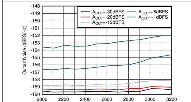
図 4-102. TX シングルトーン出力ノイズと周波数との関係 (各種振幅、2.6GHz)
