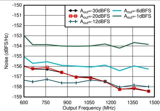
$2.6\text{GHz}$ で整合、シングルトーン、 $f_{\text{DAC}} = 11.79648\text{GSPS}$ 、インターリープモード、 $40\text{MHz}$ オフセット、DSA = 0dB
