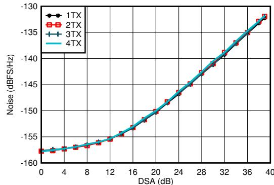
$f_{\text{DAC}} = 11796.48\text{MSPS}$ 、インターリープ モード、3.5GHz で整合、 $A_{\text{out}} = -13\text{dBFS}$ 。
