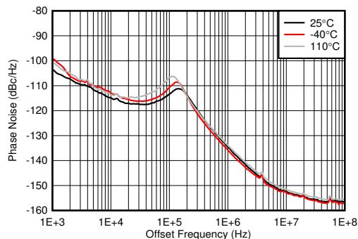
PLL イネーブル、 $f_{\text{VCO}} = 11796.48\text{MHz}$ 、 $f_{\text{REF}} = 491.52\text{MSPS}$ 、 $2\text{TXOUT}$  で測定
