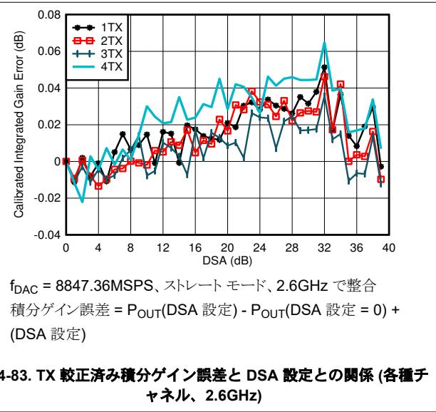
図 4-83. TX 較正済み積分ゲイン誤差と DSA 設定との関係 (各種チャネル、2.6GHz)
