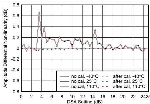
図 4-441. RX 振幅の微分非直線性 (8.11GHz)
