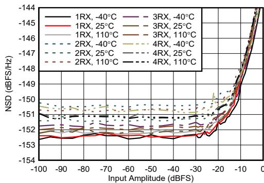
図 4-475. RX NSD とデジタル振幅との関係 (9.6GHz)
