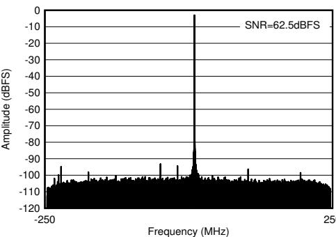
2.6GHz 整合あり、 $f_{\text{IN}} = 2610\text{MHz}$ 、 $A_{\text{IN}} = -3\text{dBFS}$
