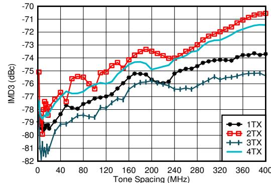
$f_{\text{DAC}} = 5898.24\text{MSPS}$ 、ストレート モード、 $f_{\text{CENTER}} = 0.85\text{GHz}$ 、0.8GHz で整合、各トーン  $-13\text{dBFS}$
