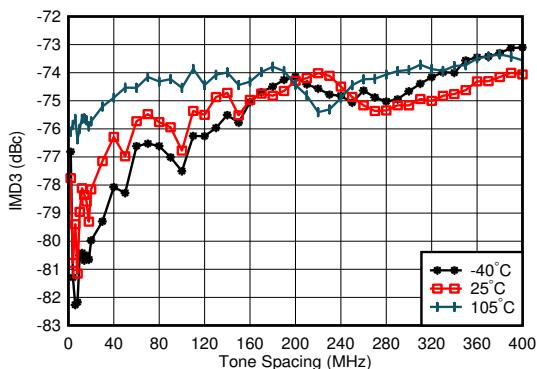
$f_{\text{DAC}} = 11796.48\text{MSPS}$ 、ストレートモード、 $f_{\text{CENTER}} = 0.85\text{GHz}$ 、 $0.8\text{GHz}$ で整合、各トーン  $-13\text{dBFS}$ 、ワーストチャネル
