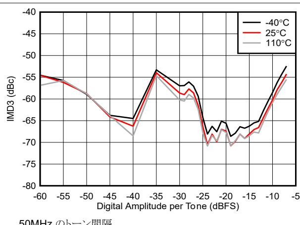
図 4-218. TX IMD3 とデジタル振幅との関係 (8.11GHz)
