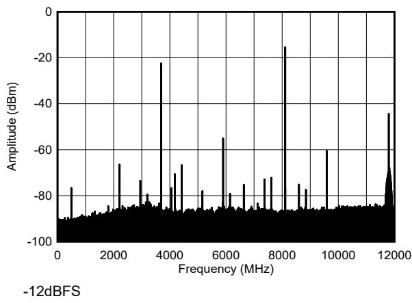
図 4-207. TX シングル トーン出力スペクトル (8.11GHz)
