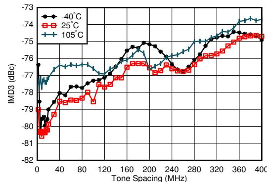
$f_{\text{DAC}} = 8847.36\text{MSPS}$ 、ストレート モード、 $f_{\text{CENTER}} = 0.85\text{GHz}$ 、0.8GHz で整合、各トーン  $-13\text{dBFS}$ 、ワースト チャネル
