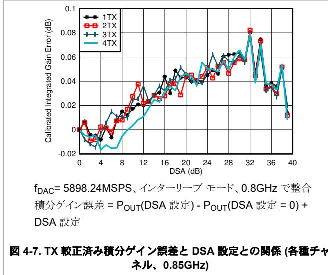
図 4-7. TX 較正済み積分ゲイン誤差と DSA 設定との関係 (各種チャネル、0.85GHz)
