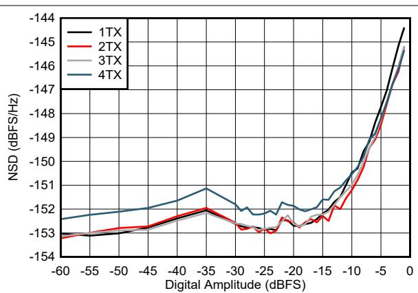
図 4-260. TX NSD とデジタル振幅との関係 (9.61GHz)
