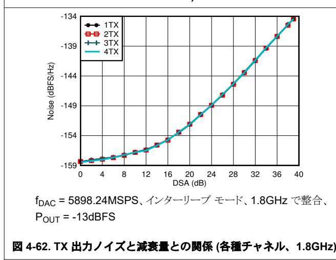
$f_{\text{DAC}} = 5898.24\text{MSPS}$ 、インターリープ モード、1.8GHz で整合、 $P_{\text{OUT}} = -13\text{dBFS}$
