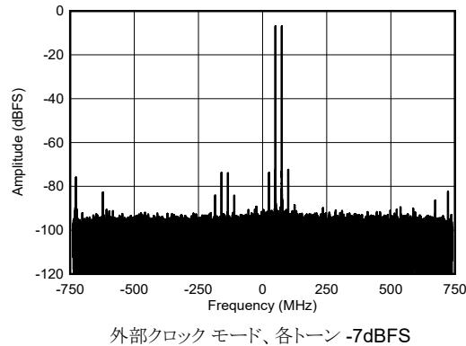
図 4-461. RX デュアル トーン出力 FFT (8.11GHz)
