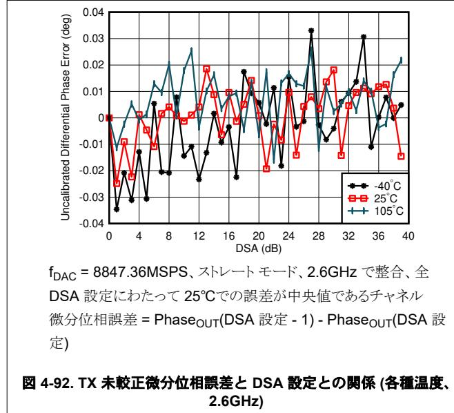
図 4-92. TX 未較正微分位相誤差と DSA 設定との関係 (各種温度、2.6GHz)
