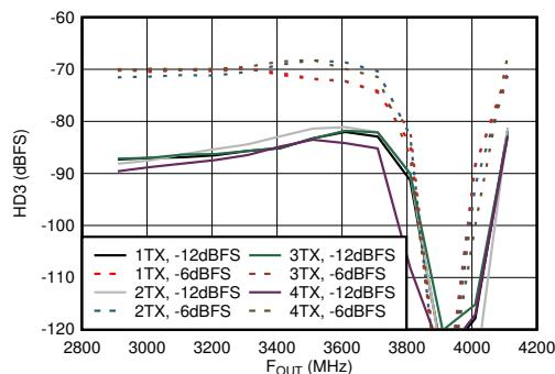
3.5GHz で整合、 $f_{\text{DAC}} = 11.79648\text{GSPS}$ 、インターリープモード、高調波周波数での出力電力で正規化。ディップは、DC付近でのHD3の低下に起因するものです。
