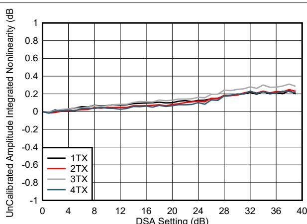
図 4-192. TX DSA 較正済み振幅の積分非直線性 (8.11GHz)
