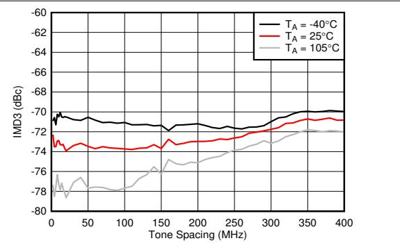
図 4-99. TX IMD3 とトーン間隔との関係 (各種温度、2.6GHz)
