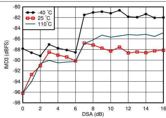
図 4-302. RX IMD3 と DSA 設定との関係 (各種温度、0.8GHz)
