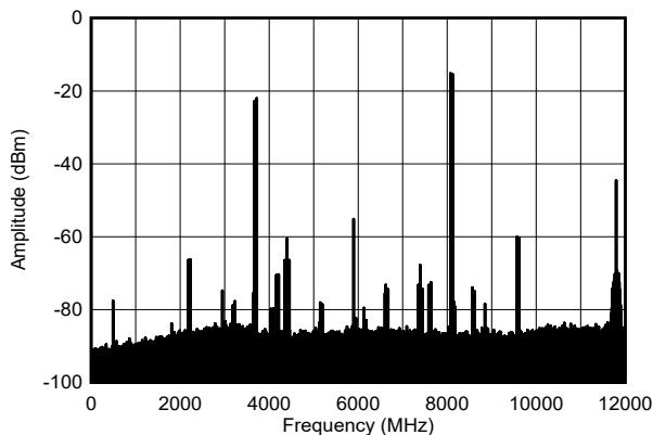
図 4-211. TX デュアル トーン出力スペクトル (8.11GHz)
