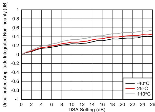
図 4-242. TX DSA 未較正振幅の積分非直線性
