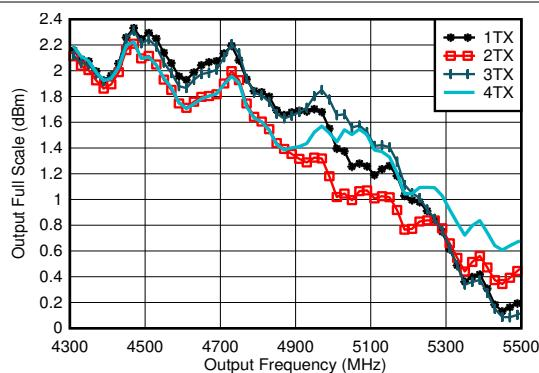
PCB とケーブルの損失を除く。 $A_{\text{OUT}} = -0.5\text{dBFS}$ 、DSA = 0、4.9GHz 整合あり。
