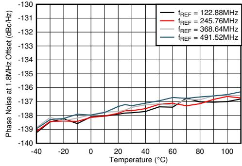
PLL イネーブル、 $f_{VCO} = 11796.48\text{MHz}$ , 2TXOUT で測定
