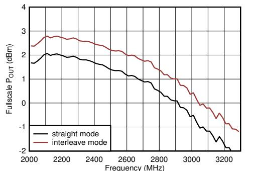
PCB とケーブルの損失を含む。 $A_{\text{out}} = -0.5\text{dBFS}$ 、DSA = 0、
