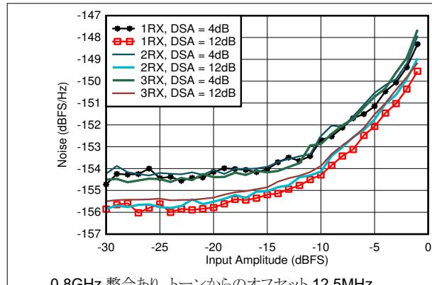
図 4-301. RX ノイズ スペクトル密度と入力振幅との関係 (各種チャネル、0.8GHz)
