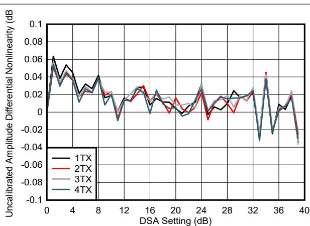
図 4-187. TX DSA 未較正振幅の微分非直線性 (8.11GHz)
