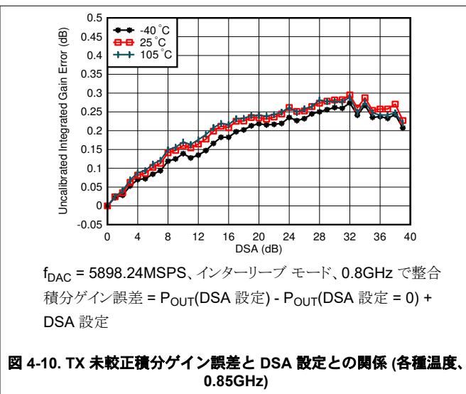
$f_{\text{DAC}} = 5898.24\text{MSPS}$ 、インターリープ モード、0.8GHz で整合
