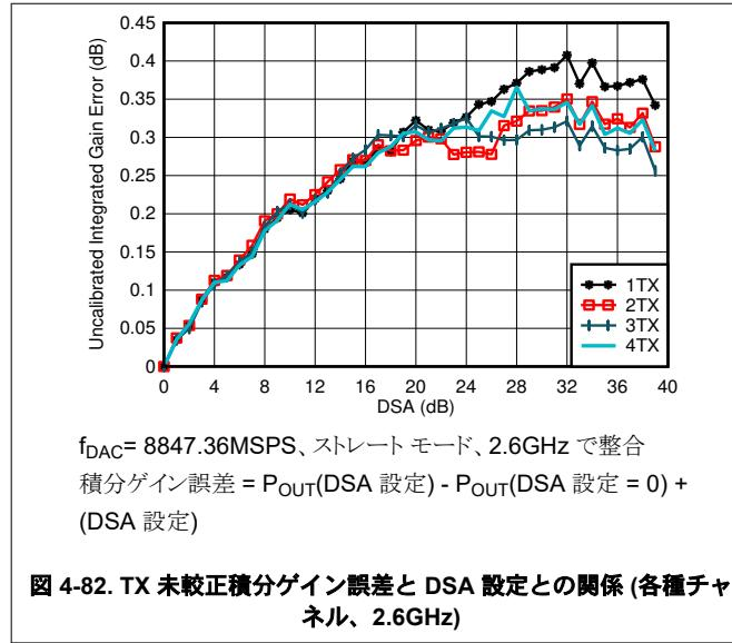
図 4-82. TX 未較正積分ゲイン誤差と DSA 設定との関係 (各種チャネル、2.6GHz)
