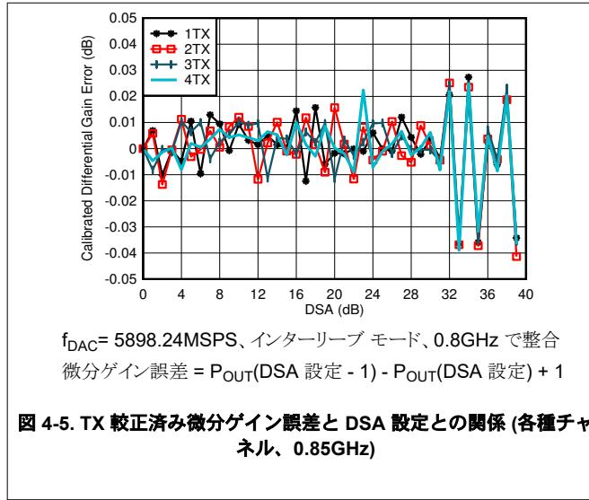
図 4-5. TX 較正済み微分ゲイン誤差と DSA 設定との関係 (各種チャネル、0.85GHz)
