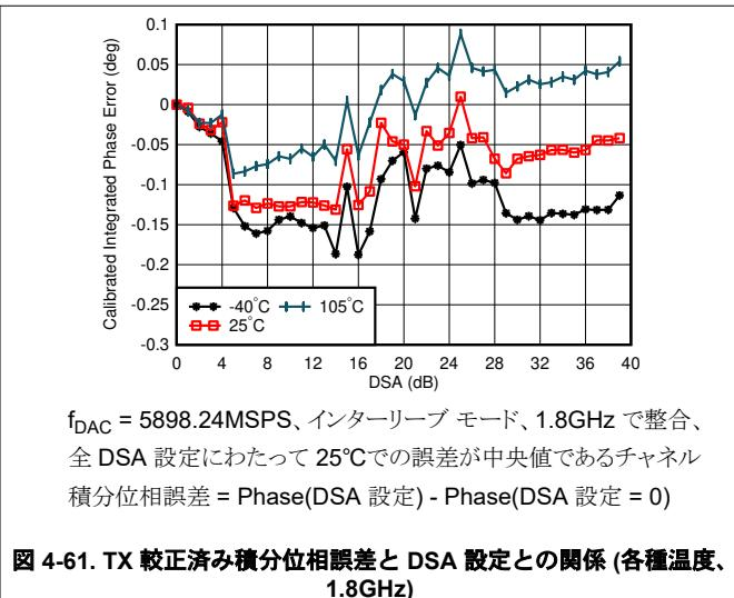
$f_{\text{DAC}} = 5898.24\text{MSPS}$ 、インターリープ モード、1.8GHz で整合、全 DSA 設定にわたって 25°Cでの誤差が中央値であるチャネル 積分位相誤差 = Phase(DSA 設定) - Phase(DSA 設定 = 0)
