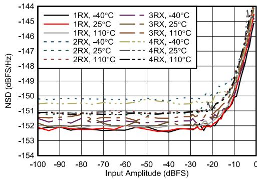
図 4-448. RX NSD とデジタル振幅との関係 (8.11GHz)
