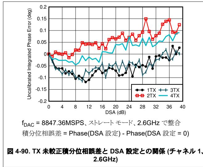
図 4-90. TX 未較正積分位相誤差と DSA 設定との関係 (チャネル 1、2.6GHz)
