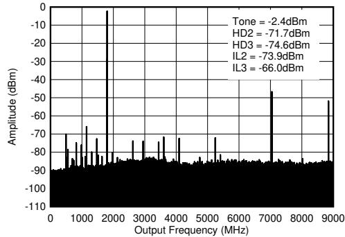
$f_{\text{DAC}} = 8847.36\text{MSPS}$ 、ストレート モード、1.8GHz 整合あり、PCB とケーブルの損失を含む。 $\text{IL}_n = f_s/n \pm f_{\text{OUT}}$  (デジタル クロックとのミキシングに起因)。
