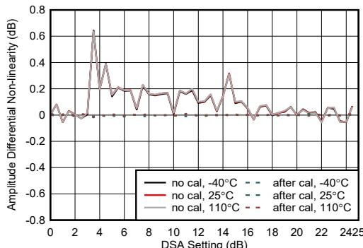
図 4-467. RX 振幅の微分非直線性 (9.6GHz)
