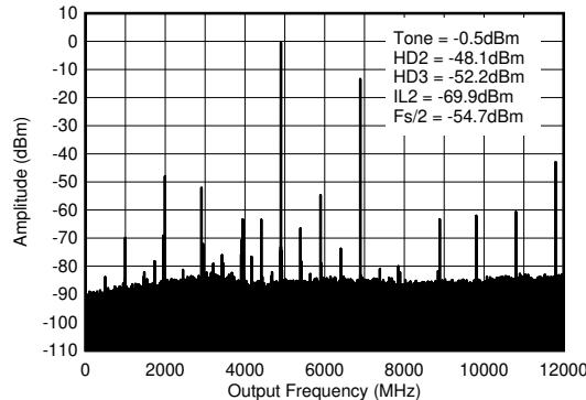
$f_{\text{DAC}} = 11796.48\text{MSPS}$ 、インターリープ モード、4.9GHz 整合あり、PCB とケーブルの損失を含む。 $\text{ILn} = f_s/n \pm f_{\text{OUT}}$ 。
