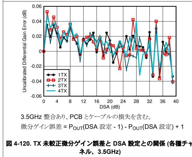
図 4-120. TX 未較正微分ゲイン誤差と DSA 設定との関係 (各種チャネル、3.5GHz)
