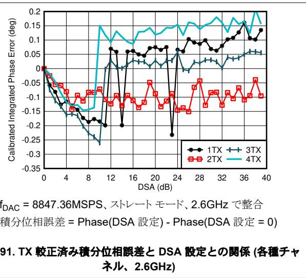
図 4-91. TX 較正済み積分位相誤差と DSA 設定との関係 (各種チャネル、2.6GHz)
