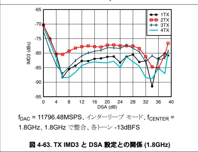
$f_{\text{DAC}} = 11796.48\text{MSPS}$ 、インターリープ モード、 $f_{\text{CENTER}} = 1.8\text{GHz}$ 、1.8GHz で整合、各トーン -13dBFS
