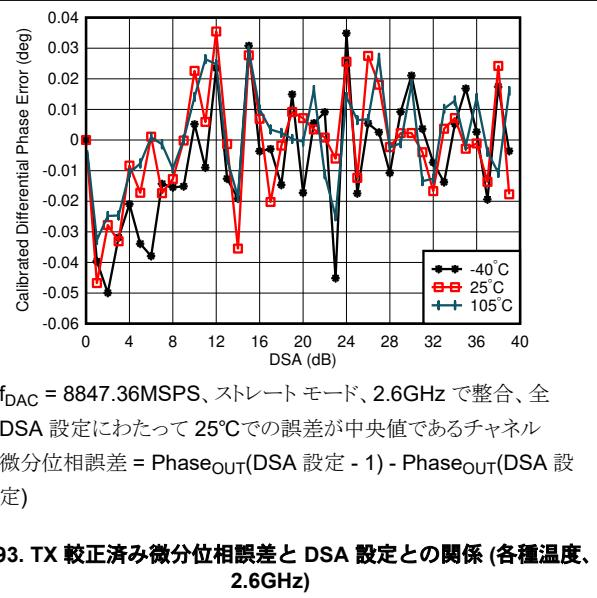
図 4-93. TX 較正済み微分位相誤差と DSA 設定との関係 (各種温度、2.6GHz)
