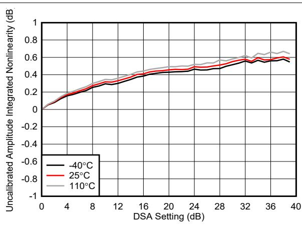
図 4-193. TX DSA 未較正振幅の積分非直線性 (8.11GHz)
