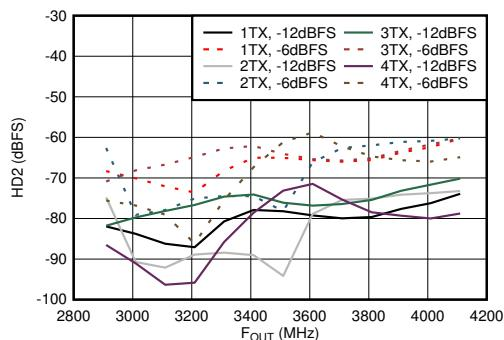
3.5GHz で整合、 $f_{\text{DAC}} = 11.79648\text{GSPS}$ 、インターリープモード、高調波周波数での出力電力で正規化
