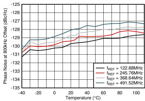
A. PLL イネーブル、 $f_{VCO} = 11796.48\text{MHz}$ , 2TXOUT で測定
