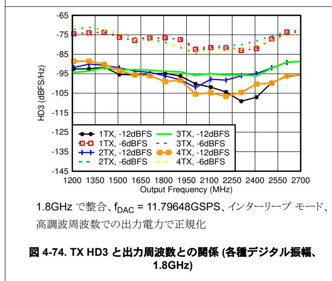
図 4-74. TX HD3 と出力周波数との関係 (各種デジタル振幅、1.8GHz)
