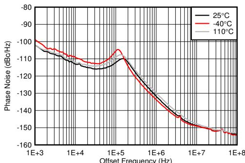
PLL イネーブル、 $f_{VCO} = 7864.32\text{MHz}$ 、 $f_{REF} = 491.52\text{MSPS}$ 、2TXOUT で測定
