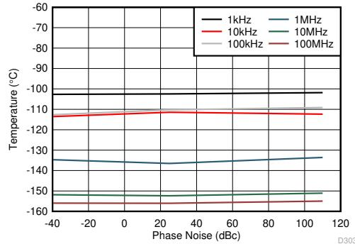
PLL イネーブル、 $f_{VCO} = 8847.36\text{MHz}$ ,  $f_{REF} = 491.52\text{MSPS}$ , 最小 LPF BW, 2TXOUT で測定
