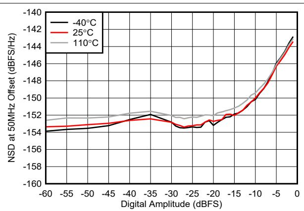
図 4-223. TX NSD とデジタル振幅との関係 (8.11GHz)
