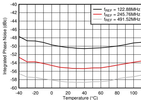
PLL イネーブル、 $f_{VCO} = 9830.4\text{MHz}$ 、1kHz ~ 100MHz、片側積分帯域幅、2TXOUT で測定
