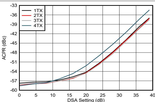
図 4-227. TX NR100MHz alt-ACPR と DSA 設定との関係 (8.11GHz)
