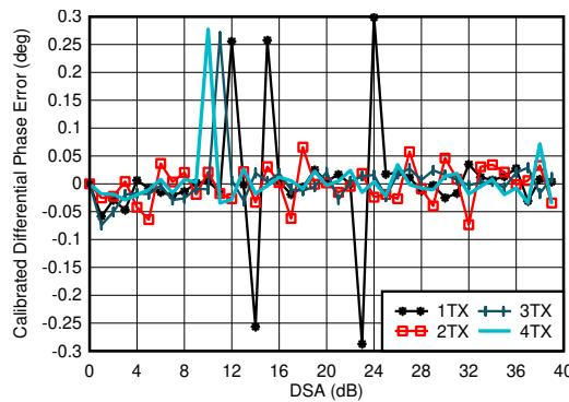
$f_{\text{DAC}} = 8847.36\text{MSPS}$ 、ストレート モード、2.6GHz で整合 微分位相誤差 =  $\text{Phase}_{\text{OUT}}(\text{DSA 設定} - 1) - \text{Phase}_{\text{OUT}}(\text{DSA 設定})$
