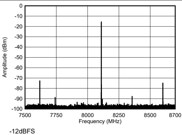
図 4-208. TX シングル トーン出力スペクトル (8.11GHz)
