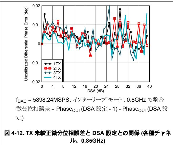
$f_{\text{DAC}} = 5898.24\text{MSPS}$ 、インターリープ モード、0.8GHz で整合
