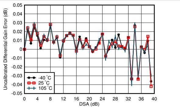
図 4-8. TX 未較正微分ゲイン誤差と DSA 設定との関係 (各種温度、0.85GHz)
