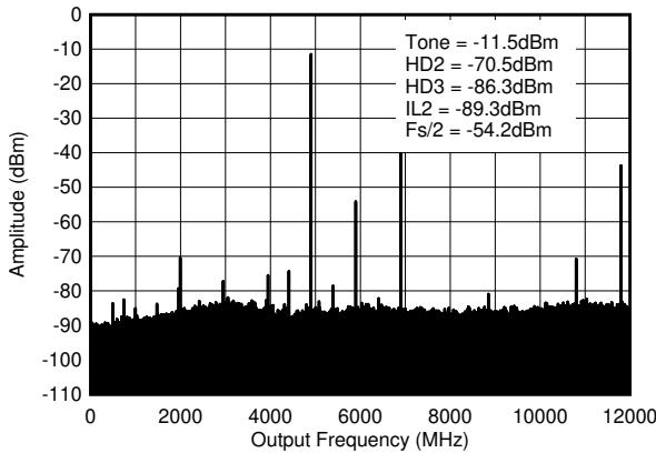
$f_{\text{DAC}} = 11796.48\text{MSPS}$ 、インターリープ モード、4.9GHz 整合あり、PCB とケーブルの損失を含む。 $\text{ILn} = f_s/n \pm f_{\text{OUT}}$ 。
