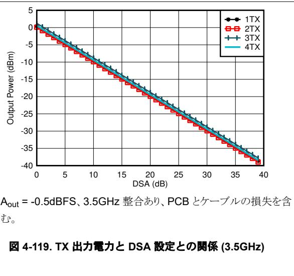
図 4-119. TX 出力電力と DSA 設定との関係 (3.5GHz)
