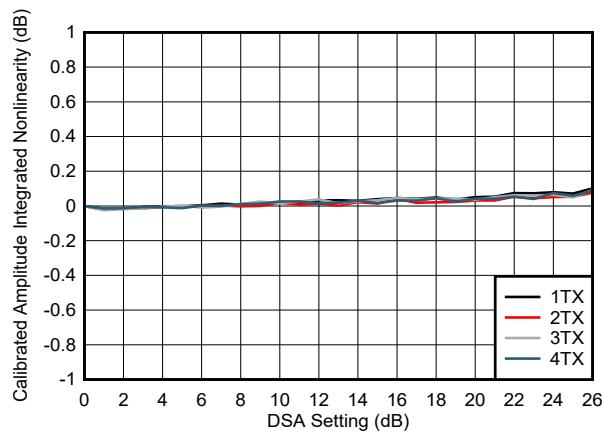
図 4-241. TX DSA 較正済み振幅の積分非直線性
