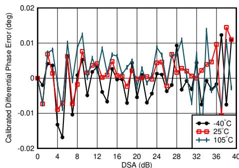
$f_{\text{DAC}} = 5898.24\text{MSPS}$ 、インターリープ モード、0.8GHz で整合、全 DSA 設定にわたって  $25^\circ\text{C}$ での誤差が中央値であるチャネル
