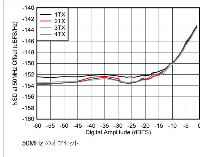
図 4-222. TX NSD とデジタル振幅との関係 (8.11GHz)
