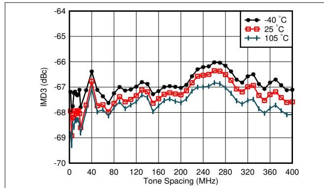
$f_{\text{DAC}} = 11796.48\text{MSPS}$ 、インターリープ モード、4.9GHz で整合、
