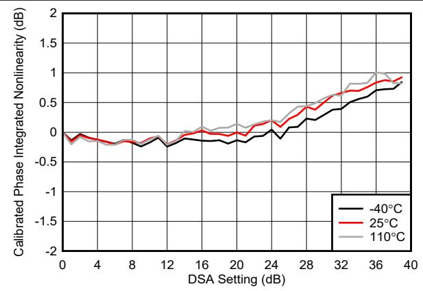
図 4-202. TX DSA 較正済み位相の積分非直線性 (8.11GHz)
