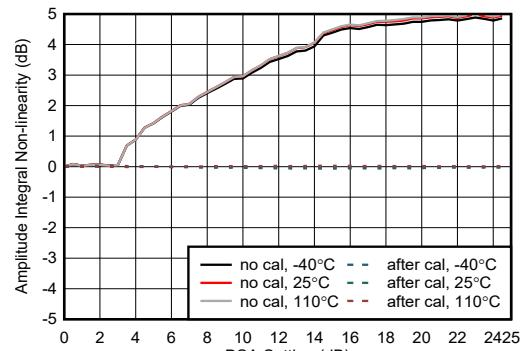
図 4-468. RX 振幅の積分非線形性 (9.6GHz)
