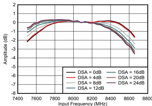
1RX および 3RX、8.11GHz で正規化
