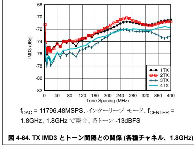
$f_{\text{DAC}} = 11796.48\text{MSPS}$ 、インターリープ モード、 $f_{\text{CENTER}} = 1.8\text{GHz}$ 、1.8GHz で整合、各トーン -13dBFS
