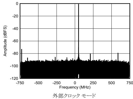
図 4-457. RX シングル トーン出力 FFT (8.11GHz, -1dBFS)
