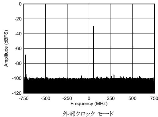
図 4-459. RX シングル トーン出力 FFT (8.11GHz, -30dBFS)
