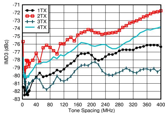
$f_{\text{DAC}} = 8847.36\text{MSPS}$ 、ストレート モード、 $f_{\text{CENTER}} = 0.85\text{GHz}$ 、0.8GHz で整合、各トーン  $-13\text{dBFS}$
