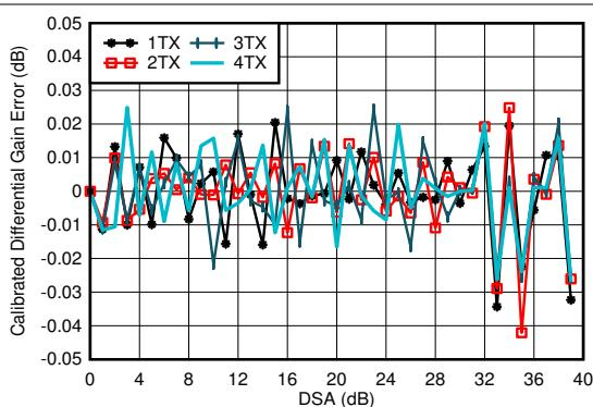
$f_{\text{DAC}} = 8847.36\text{MSPS}$ 、ストレート モード、2.6GHz で整合
