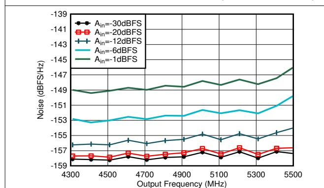
4.9GHz で整合、シングルトーン、 $f_{\text{DAC}} = 11.79648\text{GSPS}$ 、インターリープ モード、40MHz オフセット、DSA = 0dB
