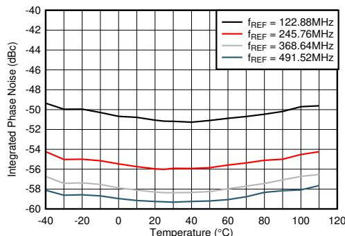
PLL イネーブル、 $f_{VCO} = 11796.48\text{MHz}$ , 1kHz ~ 100MHz, 片側
