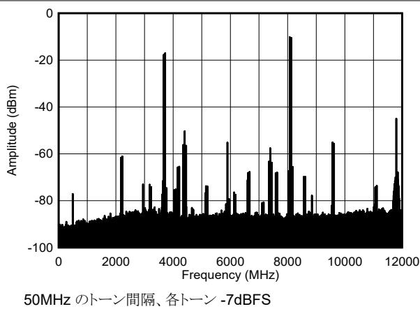
図 4-209. TX デュアル トーン出力スペクトル (8.11GHz)
