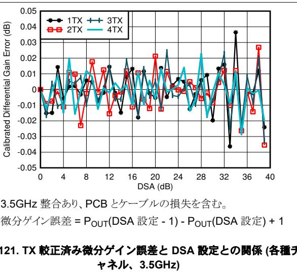
図 4-121. TX 較正済み微分ゲイン誤差と DSA 設定との関係 (各種チャネル、3.5GHz)
