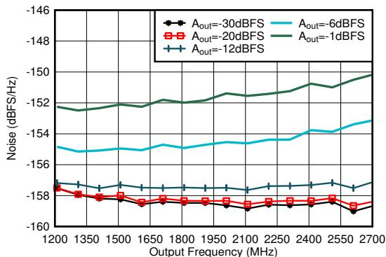
2.6GHz で整合、シングルトーン、 $f_{\text{DAC}} = 11.79648\text{GSPS}$ 、インターリーブ モード、40MHz オフセット
