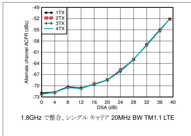
図 4-72. TX 20MHz LTE alt-ACPR と DSA 設定との関係 (1.8GHz)
