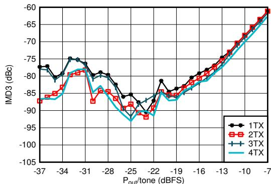
$f_{\text{DAC}} = 11796.48\text{MSPS}$ 、インターリーブ モード、 $f_{\text{CENTER}} = 1.8\text{GHz}$ 、 $f_{\text{SPACING}} = 20\text{MHz}$ 、1.8GHz で整合
