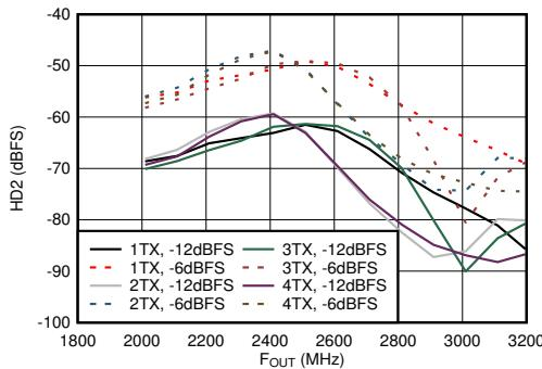
2.6GHz で整合、 $f_{\text{DAC}} = 11.79648\text{GSPS}$ 、インターリープ モード、高調波周波数での出力電力で正規化
