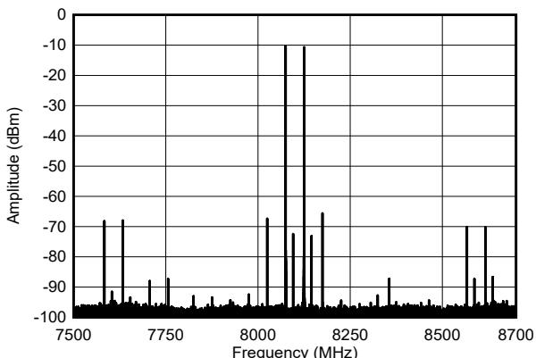
図 4-210. TX デュアル トーン出力スペクトル (8.11GHz)
