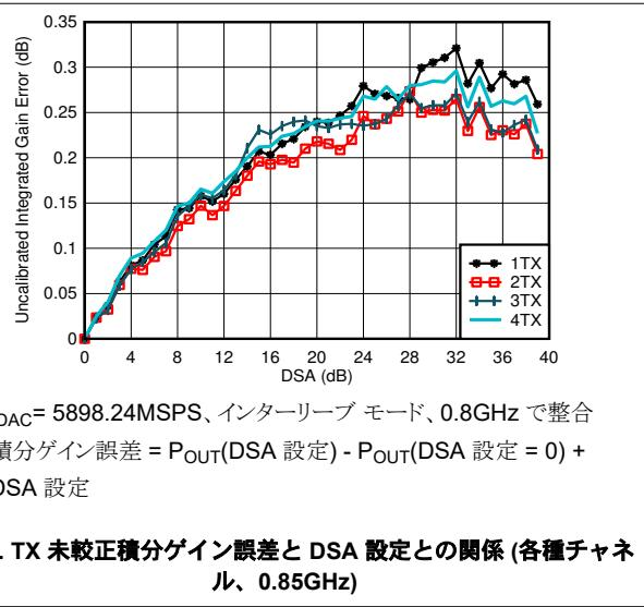
図 4-6. TX 未較正積分ゲイン誤差と DSA 設定との関係 (各種チャネル、0.85GHz)
