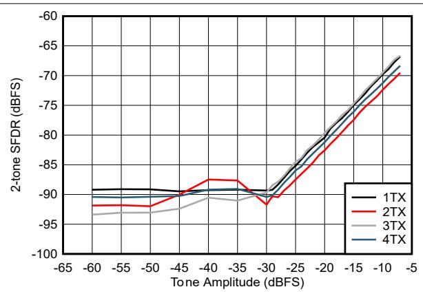
図 4-221. TX 2 トーン SFDR とデジタル振幅との関係 (8.11GHz)
