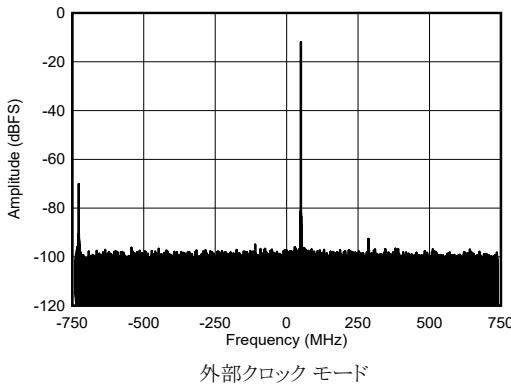
図 4-458. RX シングル トーン出力 FFT (8.11GHz, -12dBFS)
