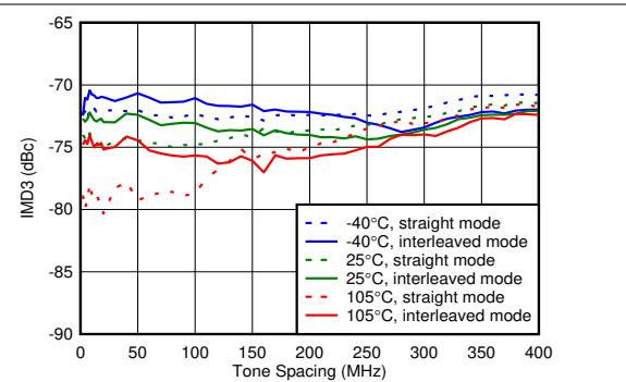
図 4-101. TX IMD3 とトーン間隔との関係 (各種温度)
