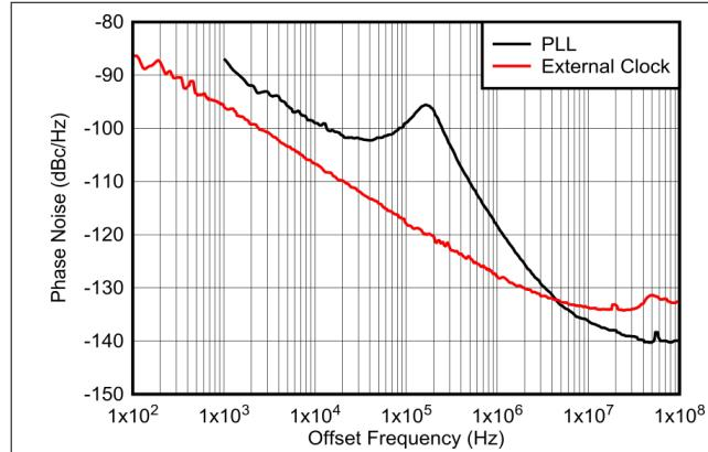
TX 出力で測定、 $20 \times \log_{10}$  で  $12\text{GHz}$  に正規化 ( $12\text{GHz}/F_{\text{OUT}}$ )
