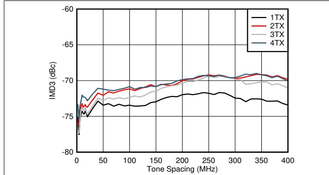
図 4-98. TX IMD3 とトーン間隔との関係 (各種チャネル、2.6GHz)
