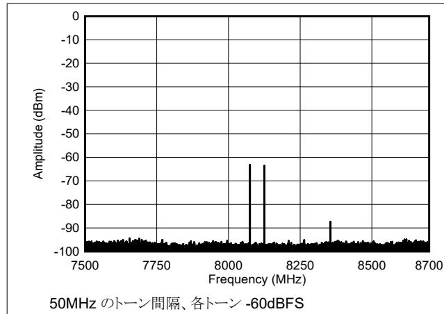
図 4-216. TX デュアルトーン出力スペクトル (8.11GHz)
