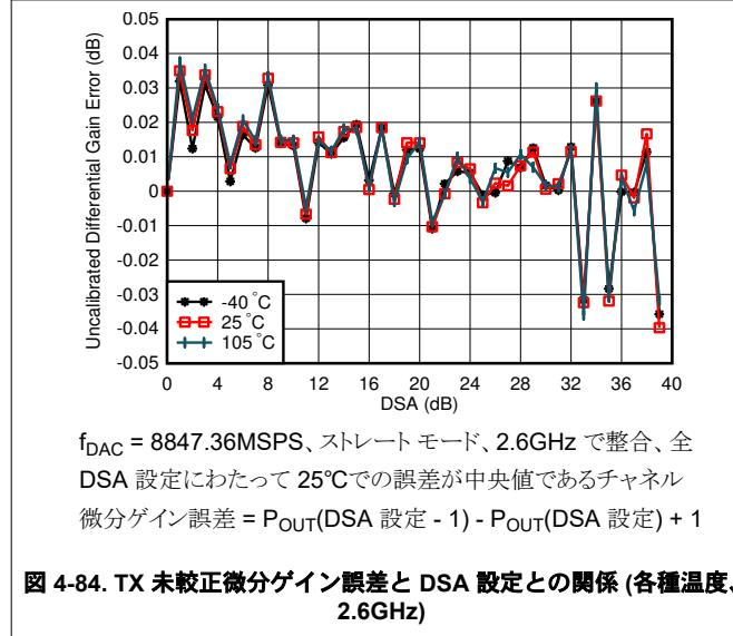
図 4-84. TX 未較正微分ゲイン誤差と DSA 設定との関係 (各種温度、2.6GHz)
