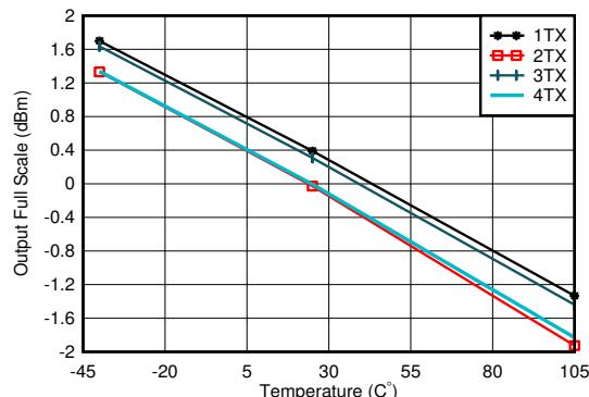
$f_{\text{DAC}} = 11796.48\text{MSPS}$ 、 $A_{\text{out}} = -0.5\text{dBFS}$ 、4.9GHz に整合
