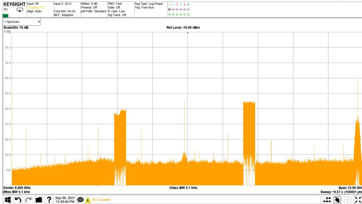
図 4-232. TX 4x100MHz NR 出力スペクトル (8.11GHz)
