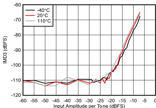
図 4-471. RX IMD3 とデジタル振幅との関係 (9.6GHz)
