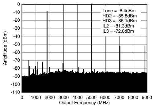
$f_{\text{DAC}} = 8847.36\text{MSPS}$ 、ストレート モード、1.8GHz 整合あり、PCB とケーブルの損失を含む。 $\text{IL}_n = f_{\text{S}/\text{n}} \pm f_{\text{OUT}}$  (デジタル クロックとのミキシングに起因)。
