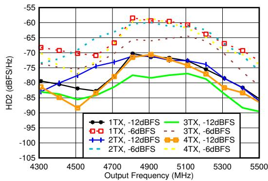
4.9GHz で整合、 $f_{\text{DAC}} = 11.79648\text{GSPS}$ 、インターリープ モード、高調波周波数での出力電力で正規化
