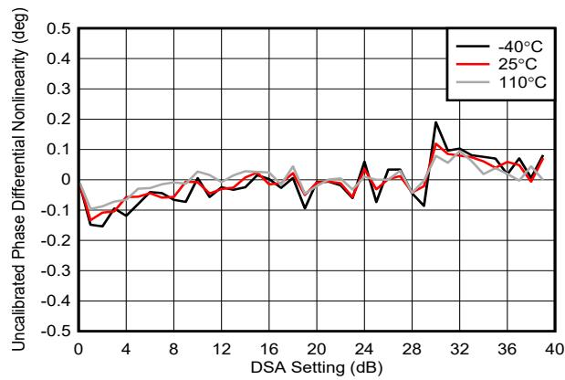
図 4-197. TX DSA 未較正位相の微分非直線性 (8.11GHz)
