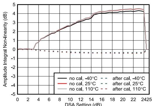
図 4-442. RX 振幅の積分非直線性 (8.11GHz)
