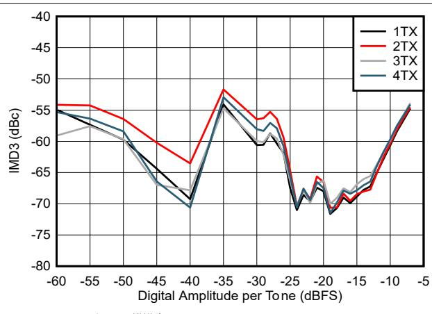
図 4-217. TX IMD3 とデジタル振幅との関係 (8.11GHz)
