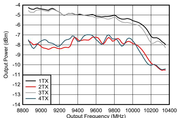
PCB とケーブルの損失を含む。
