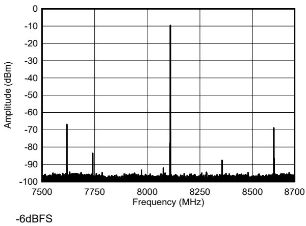
図 4-206. TX シングル トーン出力スペクトル (8.11GHz)
