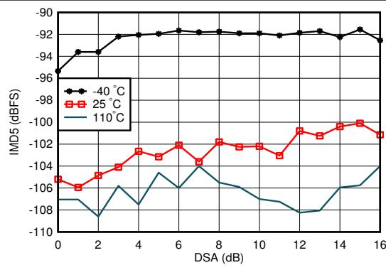
図 4-303. RX IMD5 と DSA 設定との関係 (各種温度、0.8GHz)
