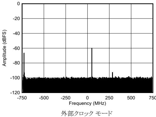
図 4-460. RX シングル トーン出力 FFT (8.11GHz, -60dBFS)
