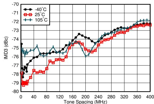
$f_{\text{DAC}} = 5898.24\text{MSPS}$ 、ストレート モード、 $f_{\text{CENTER}} = 0.85\text{GHz}$ 、0.8GHz で整合、各トーン  $-13\text{dBFS}$ 、ワースト チャネル
