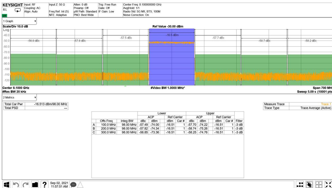
図 4-229. TX 100MHz NR 出力スペクトル (8.11GHz)
