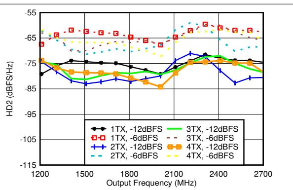
図 4-73. TX HD2 と出力周波数との関係 (各種デジタル振幅、1.8GHz)
