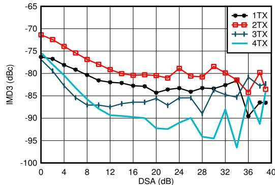
$f_{\text{DAC}} = 11796.48\text{MSPS}$ 、インターリープ モード、 $f_{\text{CENTER}} = 0.85\text{GHz}$ 、0.8GHz で整合、各トーン  $-13\text{dBFS}$
