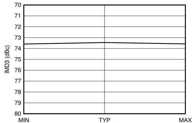
$f_{\text{DAC}} = 11796.48\text{MSPS}$ 、インターリープ モード、2.6GHz で整合。トーンから 40MHz オフセット。出力電力 = -13dBFS。すべての電源電圧に最小値、代表値、最大値がある。
