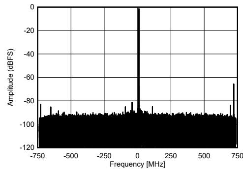
図 4-482. RX シングル トーン出力 FFT (9.61GHz)
