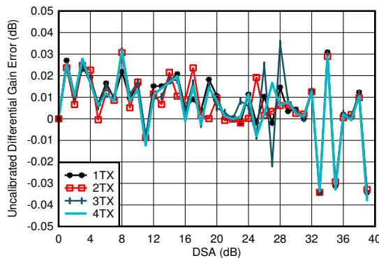
$f_{\text{DAC}} = 5898.24\text{MSPS}$ 、インターリープ モード、1.8GHz で整合
