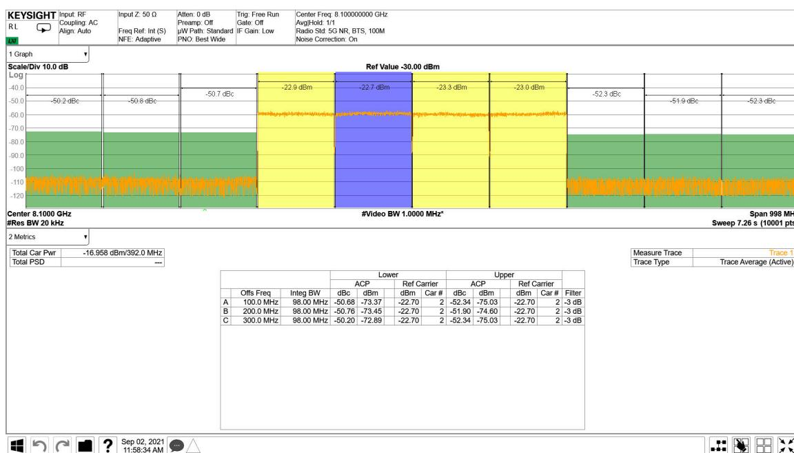
図 4-231. TX 4x100MHz NR 出力スペクトル (8.11GHz)
