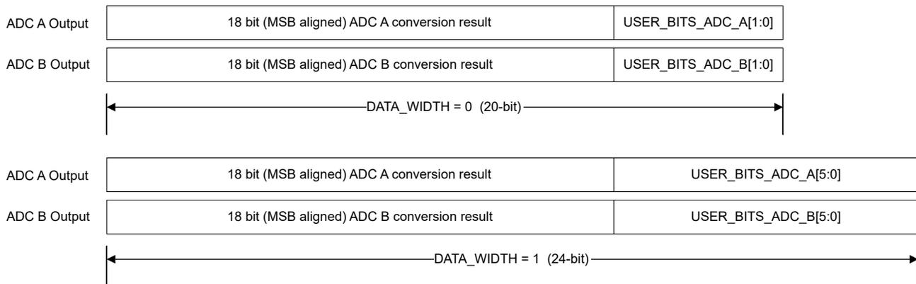
図 7-6. データ フレーム幅の構成
