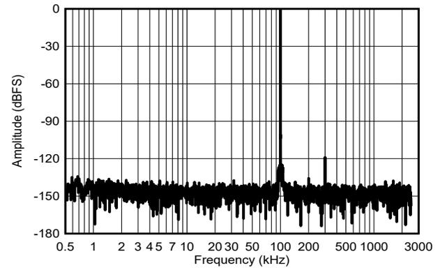
図 6-33.  $f_{IN} = 100\text{kHz}$  の標準 FFT
