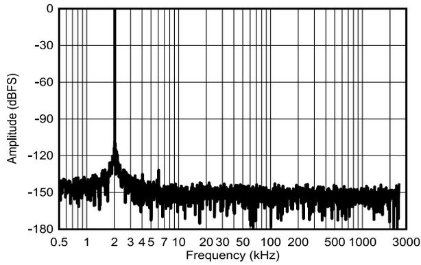
図 6-32.  $f_{IN} = 2\text{kHz}$  の標準 FFT
