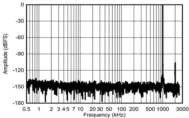
図 6-34.  $f_{IN} = 1\text{MHz}$  の標準 FFT
