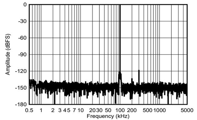
図 6-27.  $f_{IN} = 100\text{kHz}$  の標準 FFT
