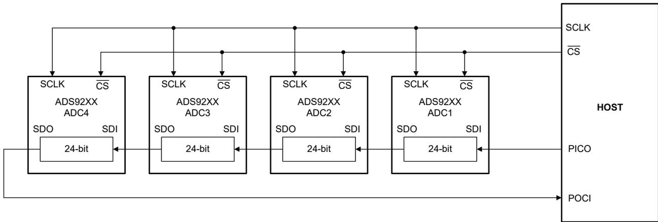
図 7-15. SPI 構成のデジチェーン接続
