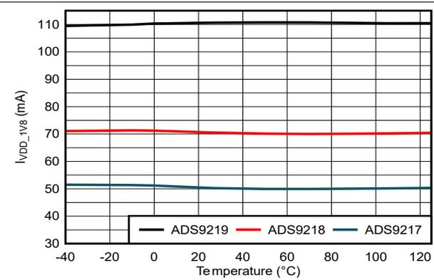
図 6-18. VDD\_1V8 電流と温度との関係
