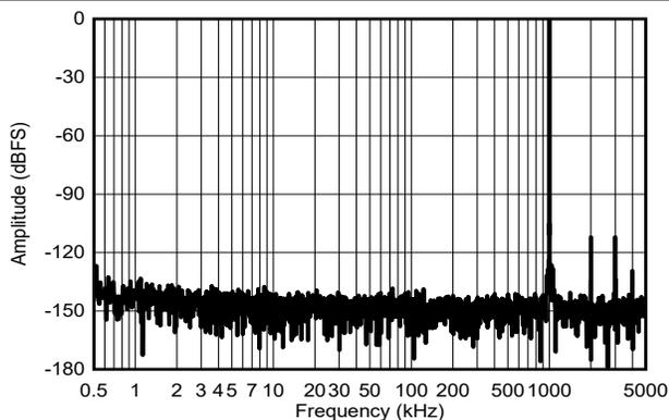
図 6-28.  $f_{IN} = 1\text{MHz}$  の標準 FFT
