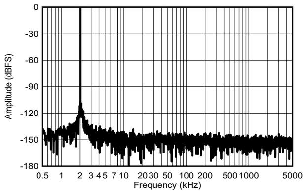
図 6-26.  $f_{IN} = 2\text{kHz}$  の標準 FFT
