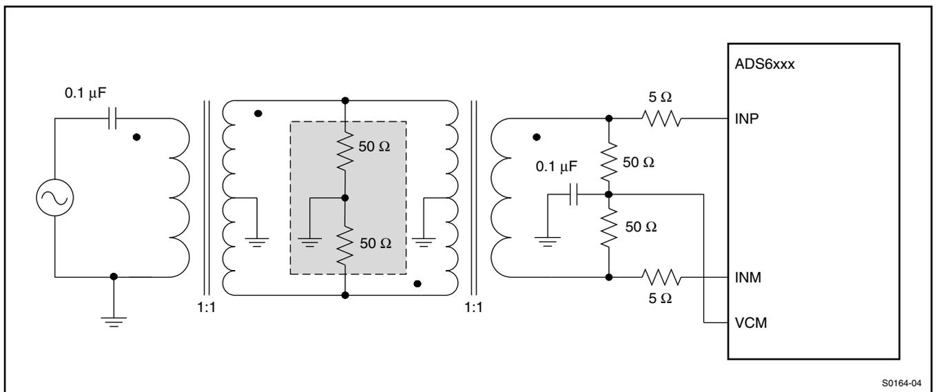
図 83. 2個のトランスを使用した駆動回路
