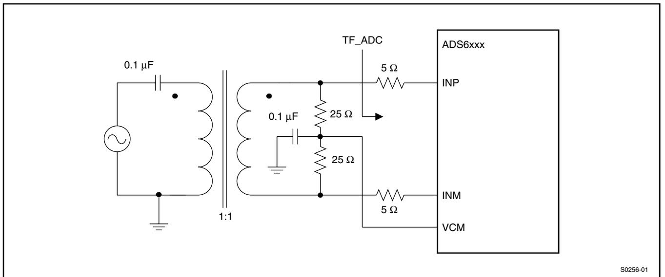
図 82. 1個のトランスを使用した駆動回路
