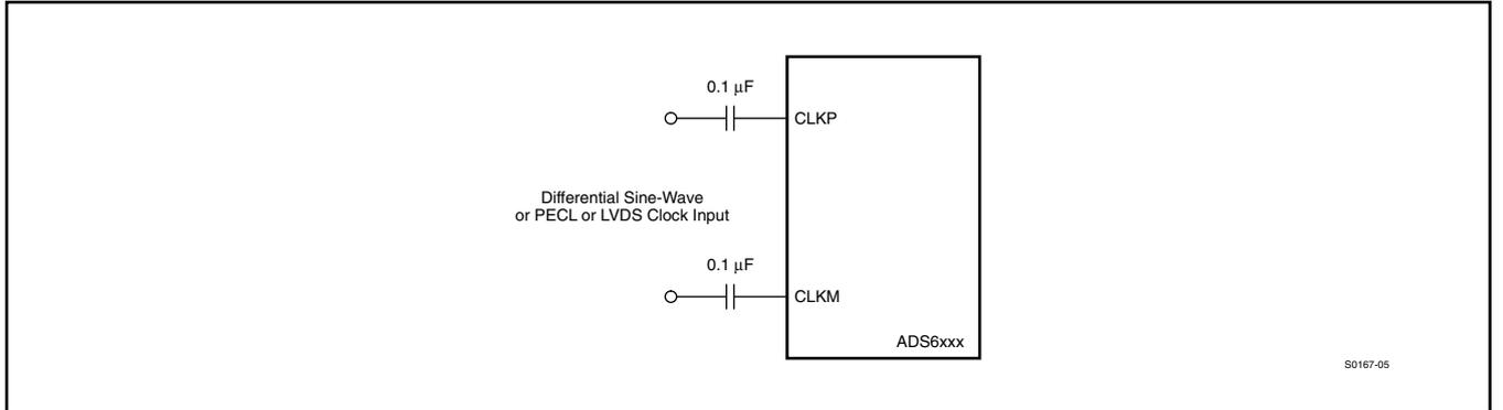
図 88. 差動クロック駆動回路
