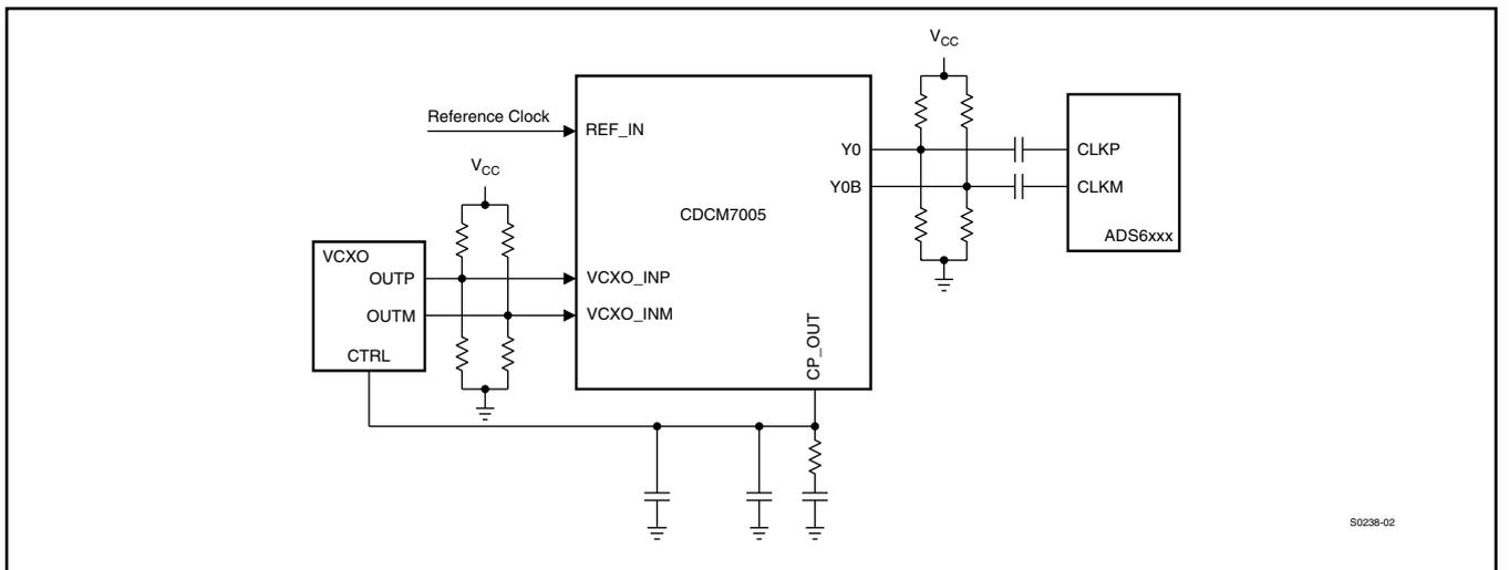
図 89. CDCM7005を使用したPECLクロック駆動
