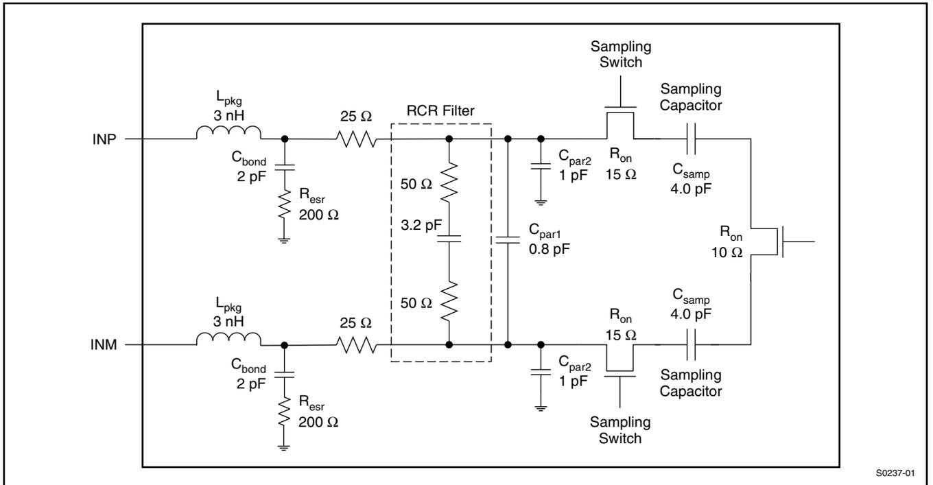
図 79. 入力サンプリング回路
