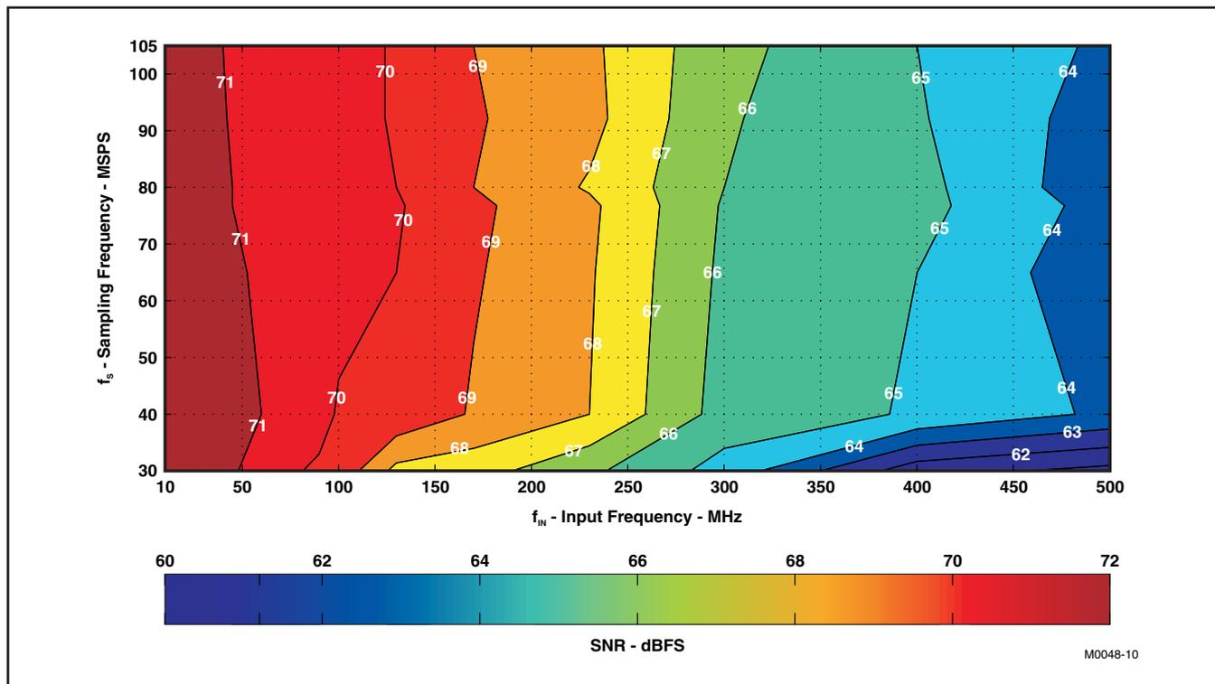
図 77. SNRの輪郭プロット (ゲインなし)
