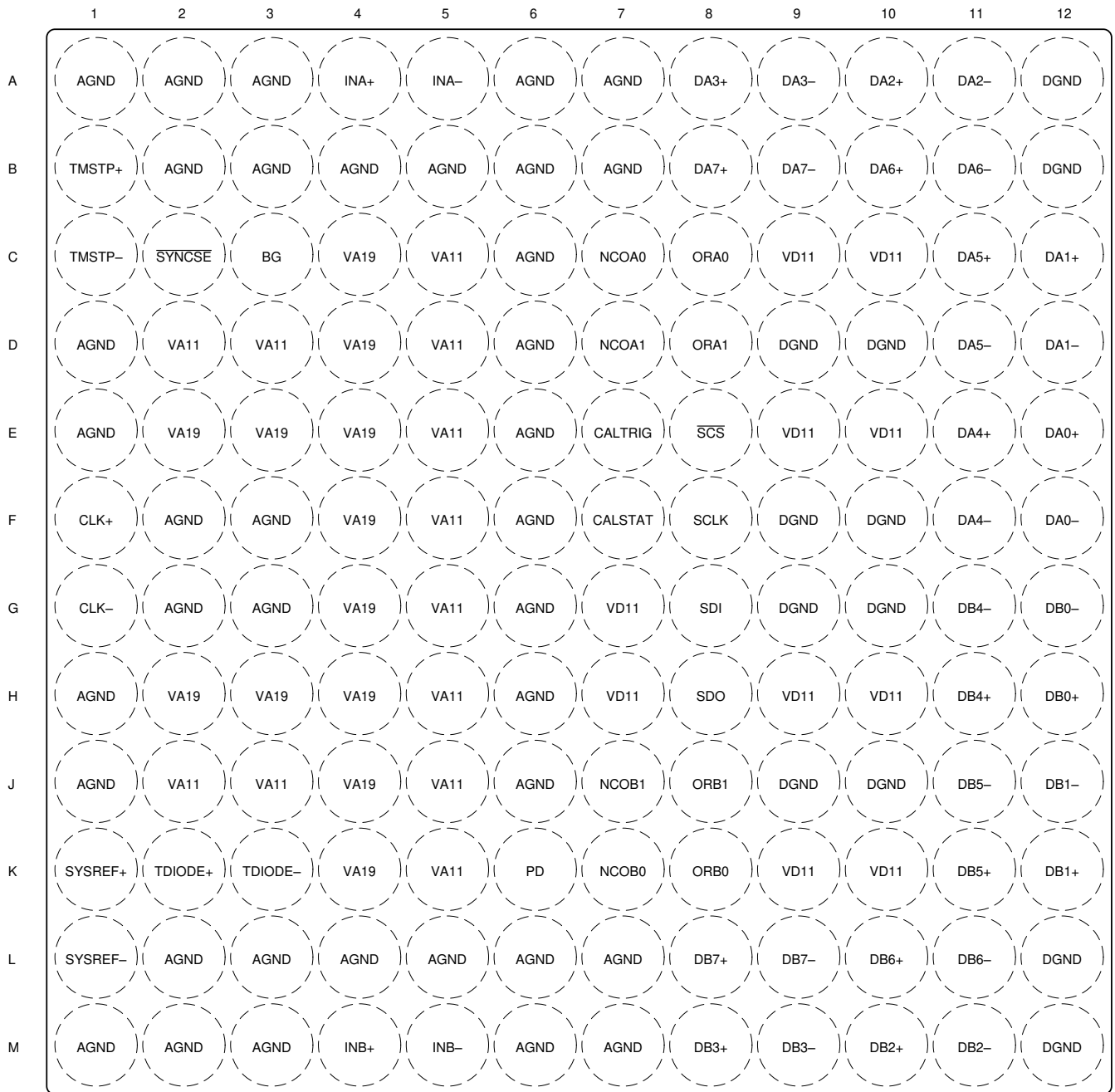
図 4-1. ALR パッケージ、144 ボール フリップ チップ BGA (上面図)
