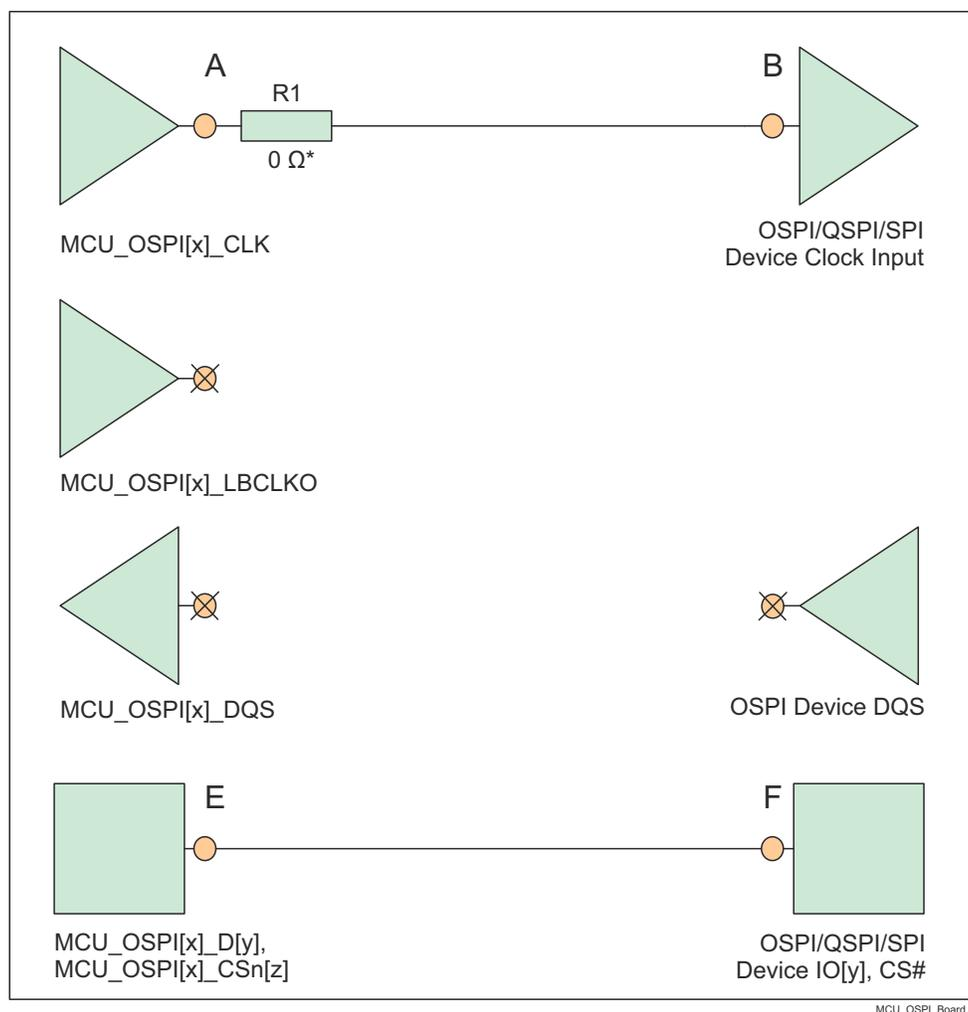
\* 0Ω 抵抗 (R1) は、MCU\_OSPI[x]\_CLK ピンのできるだけ近くに配置して、必要に応じて微調整するためのプレースホルダです。
