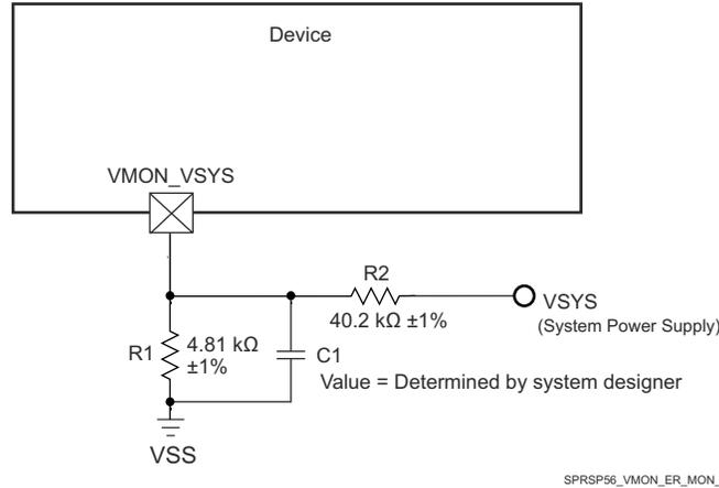
図 7-5. システム電源監視分圧回路
