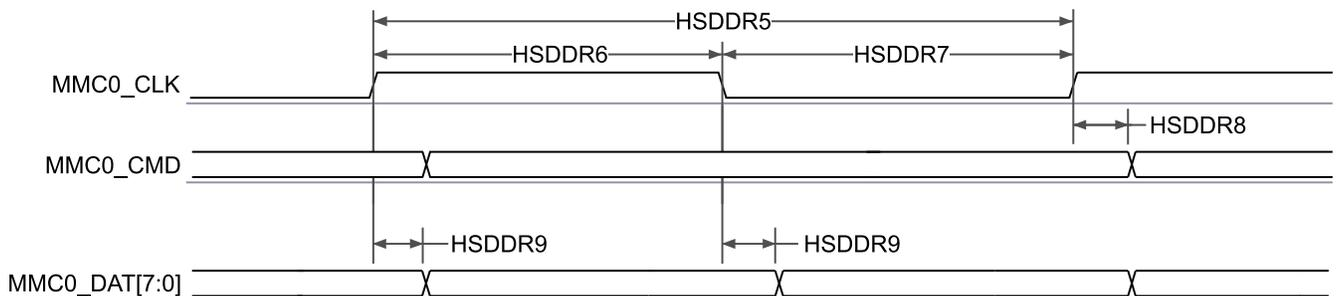
**図 6-82. MMC0 – 高速 DDR モード – 送信モード**
