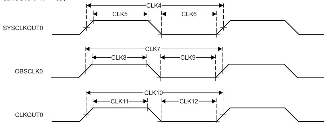
**図 6-22. クロックのスイッチング特性**
