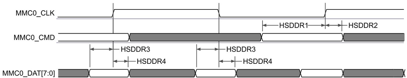
**図 6-81. MMC0 – 高速 DDR モード – 受信モード**
