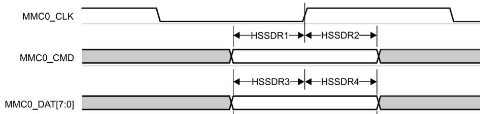
図 6-79. MMC0 – 高速 SDR モード – 受信モード
