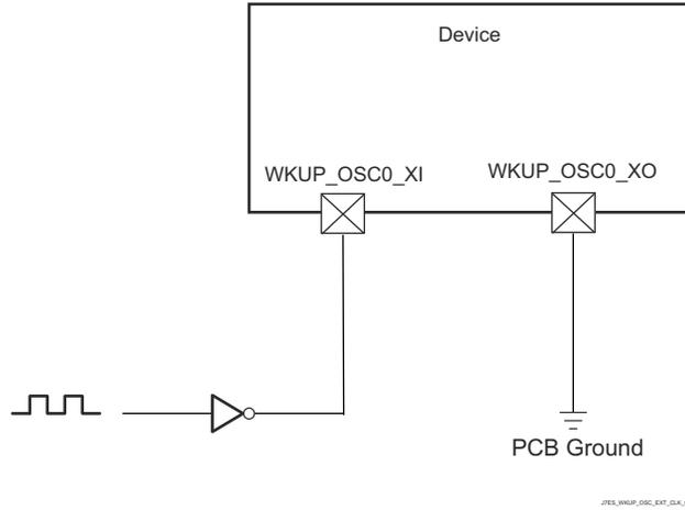
図 6-27. 1.8V LVCMOS 互換クロック入力
