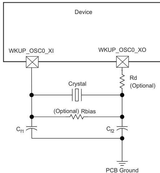
図 6-23. WKUP\_OSC0 水晶振動子の実装
