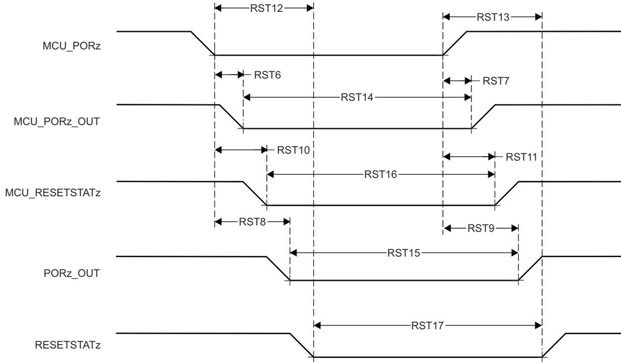
**図 6-12. MCU\_PORz 開始、MCU\_PORz\_OUT、PORz\_OUT、MCU\_RESETSTATz、RESETSTATz のスイッチング特性**
