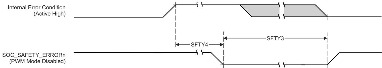
図 6-20. SOC\_SAFETY\_ERRORn のスイッチング特性
