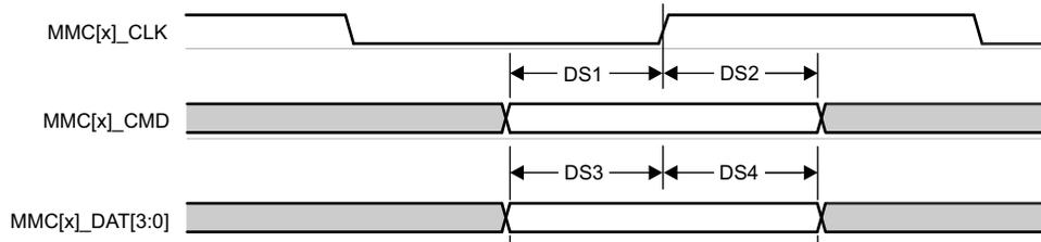
図 6-86. MMC1/2 – デフォルト速度 – 受信モード
