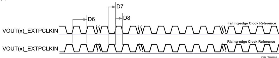
**図 6-43. DPI 外部ピクセル クロック入力**
