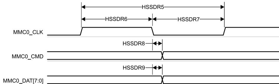
図 6-80. MMC0 – 高速 SDR モード – 送信モード
