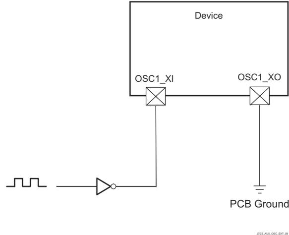
図 6-32. 1.8V LVCMOS 互換クロック入力
