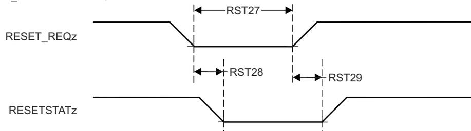
図 6-15. RESET\_REQz 開始、RESETSTATz のタイミング要件とスイッチング特性
