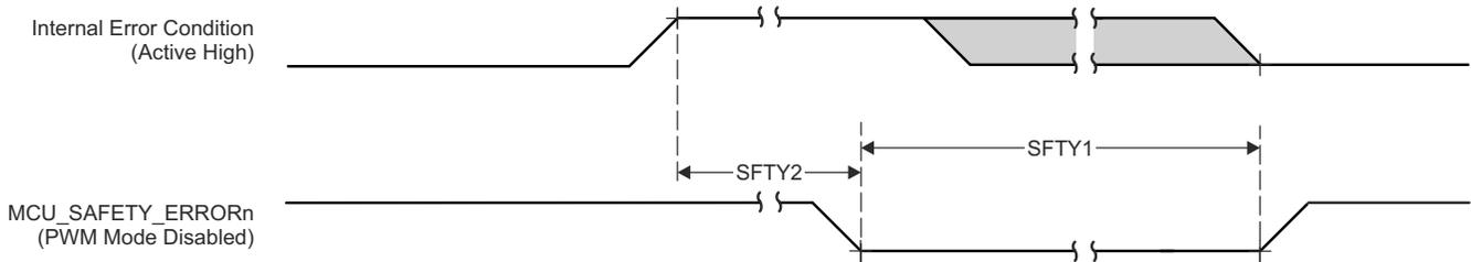
図 6-19. MCU\_SAFETY\_ERRORn のスイッチング特性
