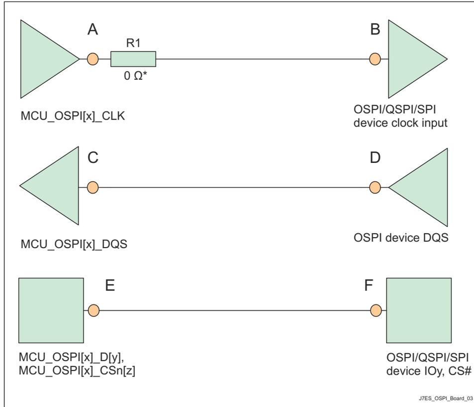
\* 0Ω 抵抗 (R1) は、MCU\_OSPI[x]\_CLK ピン のできるだけ近くに配置して、必要に応じて微調整するためのプレースホルダです。
