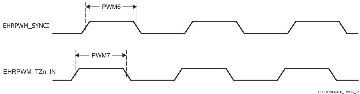
図 6-46. ePWM\_SYNCI および ePWM\_TZn\_IN の出カタイミング
