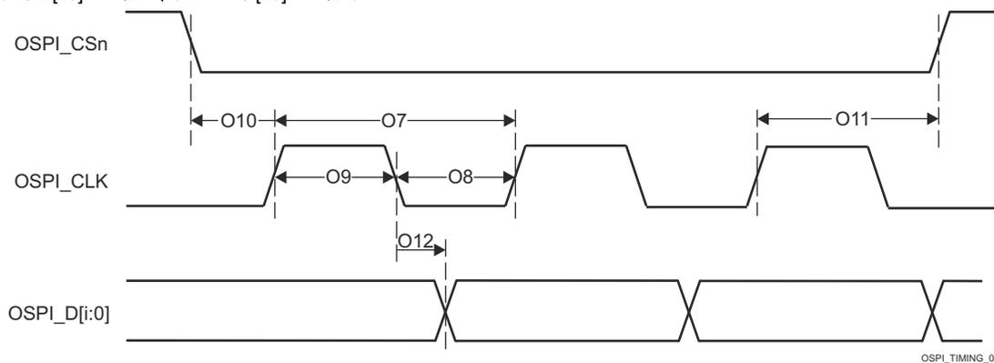
図 6-104. OSPI のスイッチング特性 – SDR
