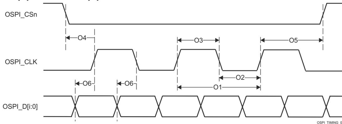
図 6-106. OSPI のスイッチング特性 – DDR
