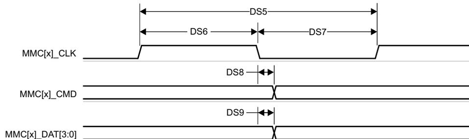
図 6-87. MMC1/2 – デフォルト速度 – 送信モード
