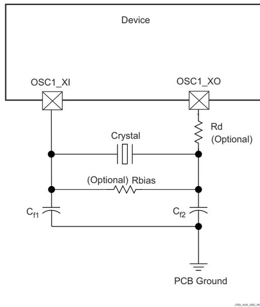
図 6-28. OSC1 水晶振動子の実装
