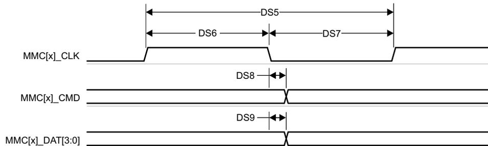
図 6-87. MMC1/MMC2 – デフォルト速度 – 送信モード
