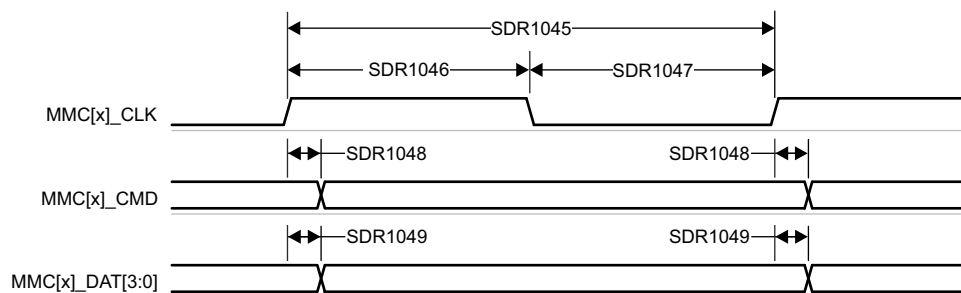
図 7-82. MMC0 – UHS-I SDR104 – 送信モード
