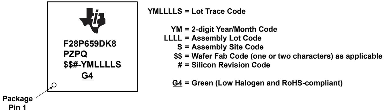
图 2-7. PZP 封装的封装编号法 - 汽车
