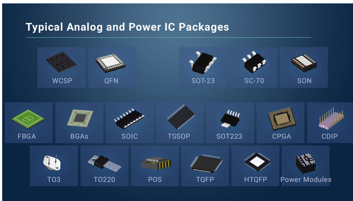
图 3. 用于模拟和电源管理 IC 的常见封装类型和微型塑料封装。
