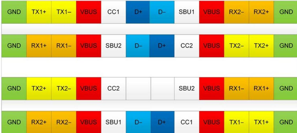
图 14.Type-C 引脚排列 - 插座 (顶部)、插头 (底部)。
