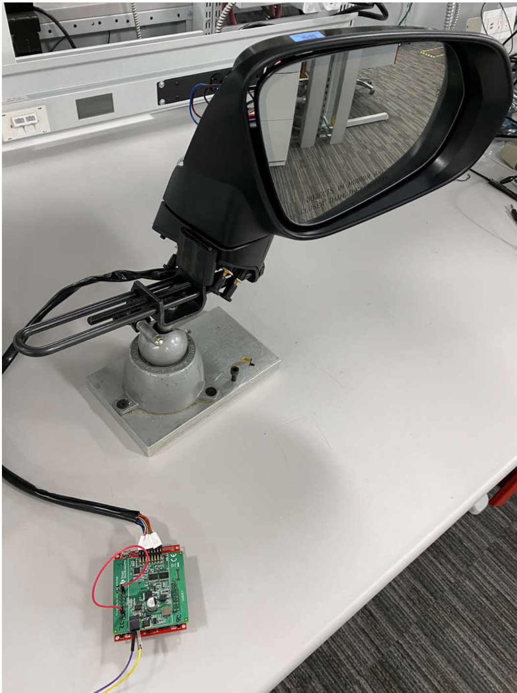
图 3-5. TIDA-020027 测试设置
