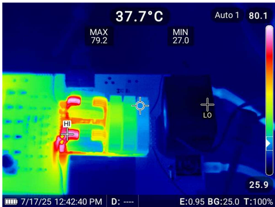
图 3-6. 热成像 ( 48V - 12V、2kW、25°C 环境温度、41.2 立方英尺/分钟风速 )
