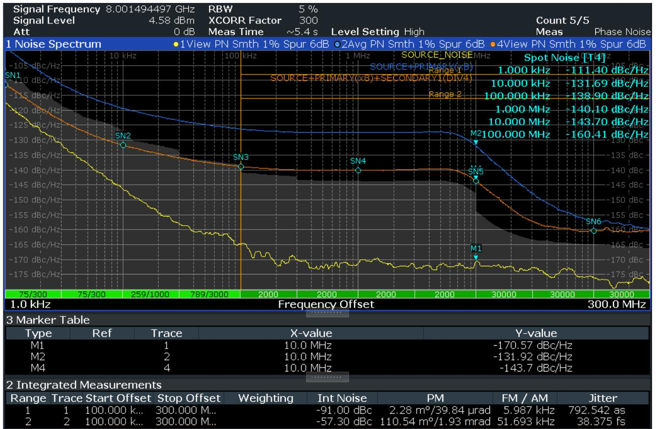
图 4-6. 倍频器模式 ( $\times 8$ )、1GHz 基准和 ( $\div 4$ ) 分频器模式的相位噪声图
