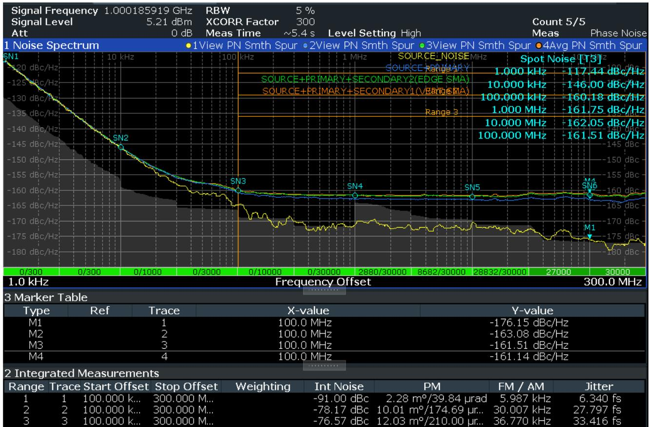
图 4-3. 缓冲器模式下的相位噪声
