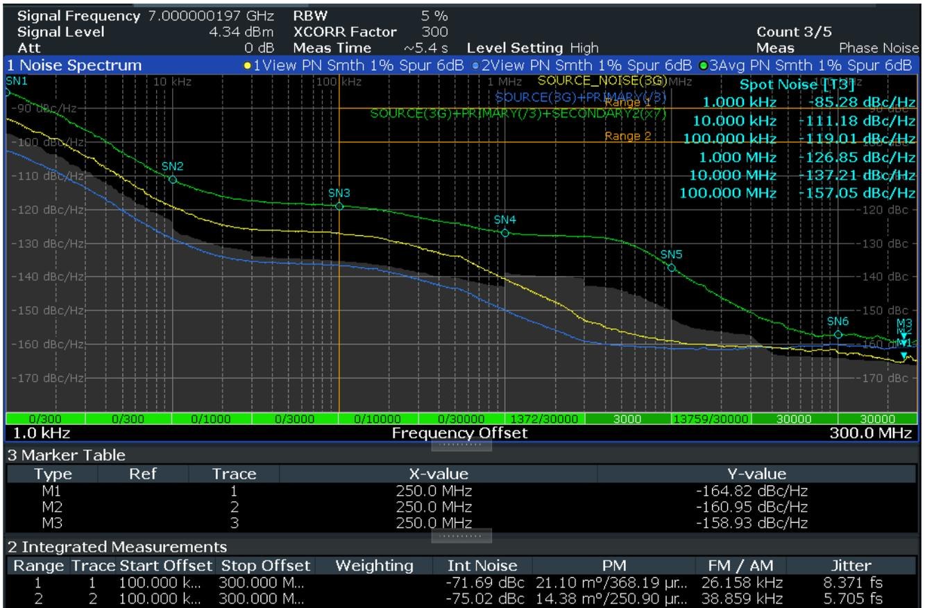
图 4-7. 3GHz、(÷ 3) 分频器模式和倍频器模式 (× 7) 下基准的相位噪声图
